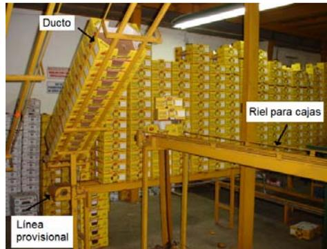
**FIGURA 2.11 EQUIPO AUXILIAR PARA ABASTECER CAJAS AL ÁREA DE EMPACADO**
