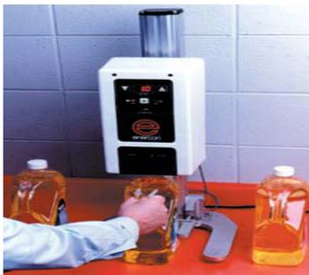
También sella envases tapados, incluso aquellos que poseen tapas que no ejercen suficiente presión sobre el liner. Posee un cabezal desellado neumático, el cual aplica presión al liner durante el proceso de sellado. Para operar, simplemente ubique el envase en posición de sellado y utilice los interruptores para activar el cabezal de sellado. El cabezal neumático baja y automáticamente se aplica potencia. El tiempo desellado es tan corto como 3/10 de segundo.
