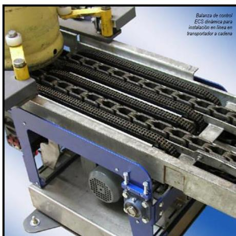
**FIGURA 2.5. DISPOSITIVO DE CONTROL DE PESO DURANTE LA TRANSPORTACIÓN**
