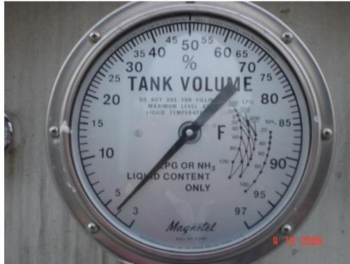
**FIGURA 3.3 VISTA EXTERIOR DE UN DISPOSITIVO DE MEDICIÓN DE NIVEL DE LLENADO TIPO MAGNÉTICO**
