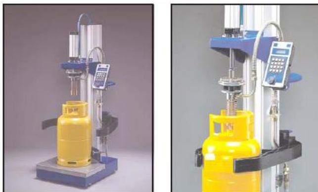
**FIGURA 2.12 CORRECTO EMPALME DE UN CABEZAL DE LLENADO CON LA VÁLVULA DE UN CILINDRO**
