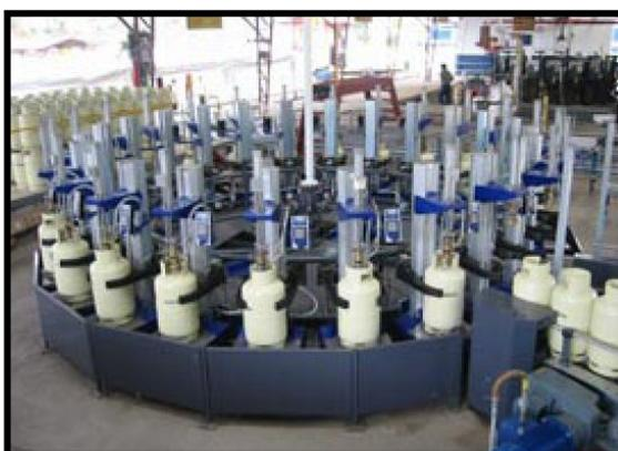
**FIGURA 2.3 CARRUSEL DE ENVASADO DE CILINDROS DE GLP**
