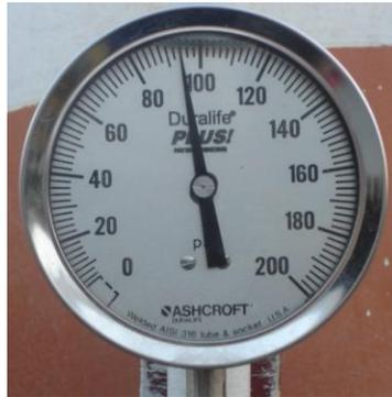
**FIGURA 3.7 DIAL DE UN MANÓMETRO EN UN TANQUE ESTACIONARIO DE GLP.**
