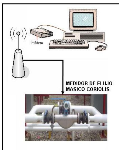
**FIGURA 4.11 ESQUEMA DE TRANSMISIÓN REMOTA PARA MEDIDOR MÁSICO**
