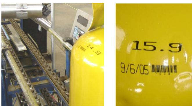
**FIGURA 2.10 MARCA DEL PESO VACÍO DE FÁBRICA DEL CILINDRO (TARA)**
