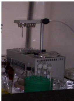
FIGURA 2.21 CONCENTRACIÓN DE LA MUESTRA CON NITRÓGENO
