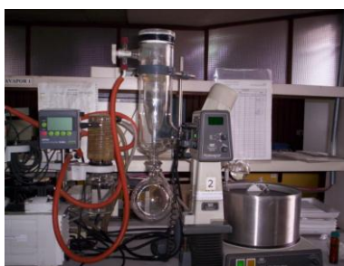
FIGURA 2.20 CONCENTRACIÓN DE LA MUESTRA BANANO CON ROTAEVAPORADOR
