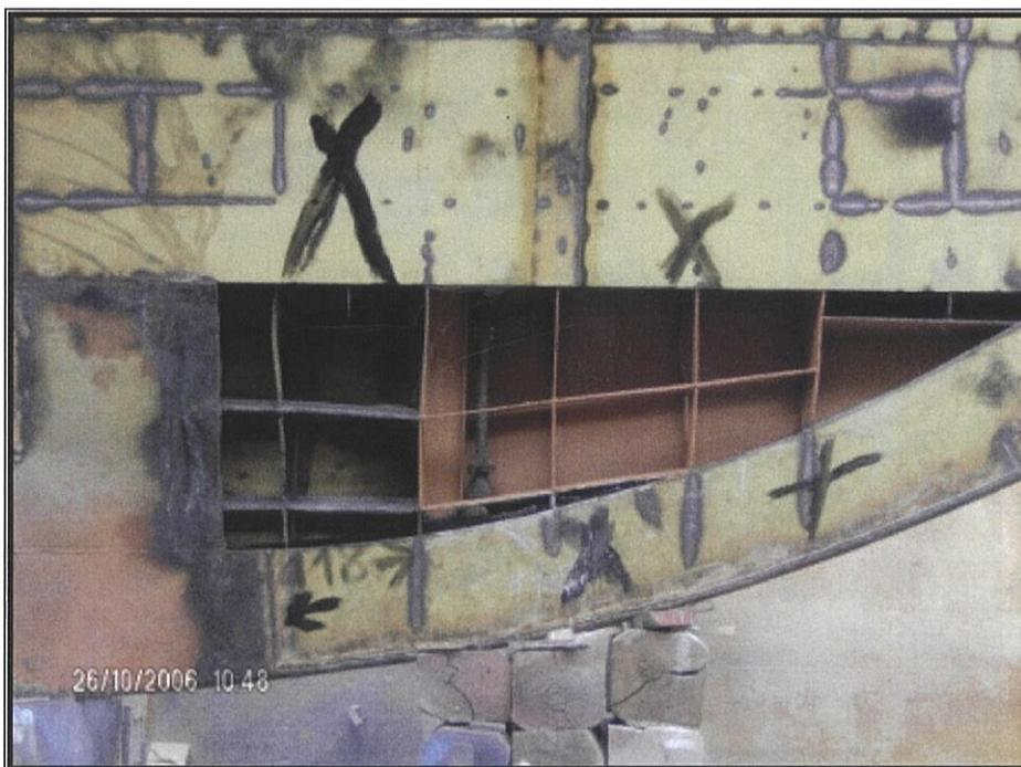
**Figura 45.** Vista lateral de la nueva quilla instalada en el sector de la roda, [1]
