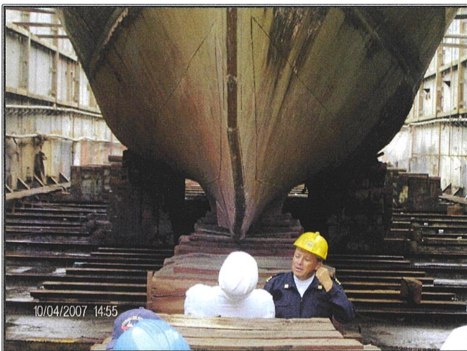
**Figura 44.** Deformación en la roda de la Corbeta, [1]
