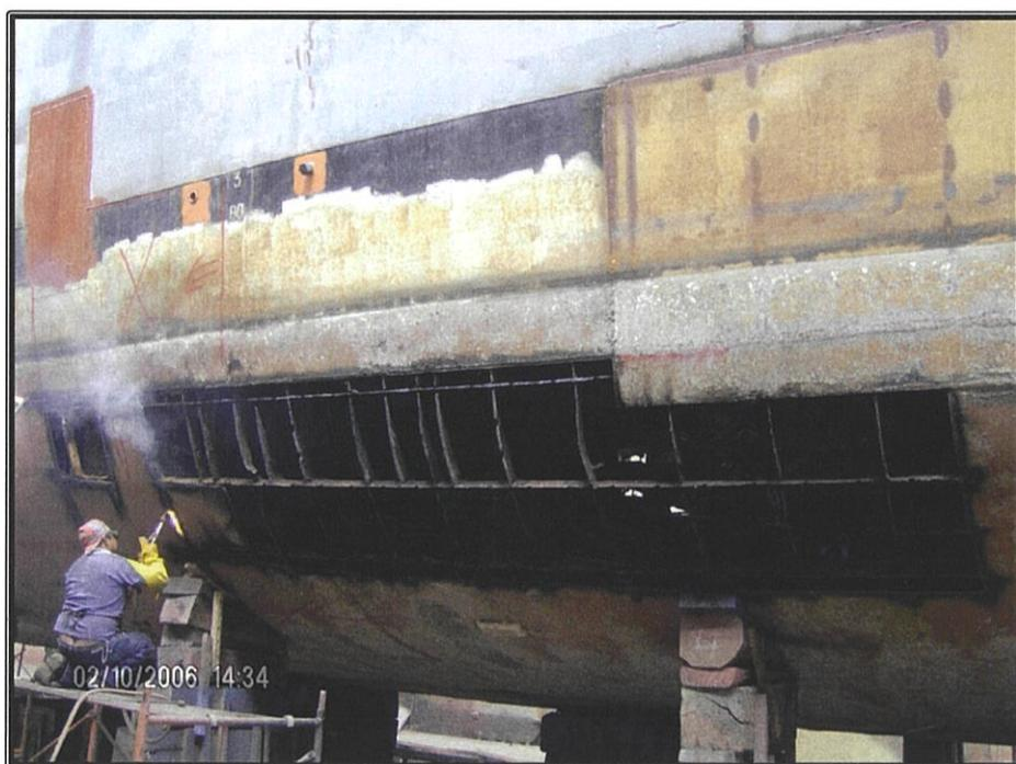
**Figura 39.** Corte y retiro del planchaje del casco, [1]
