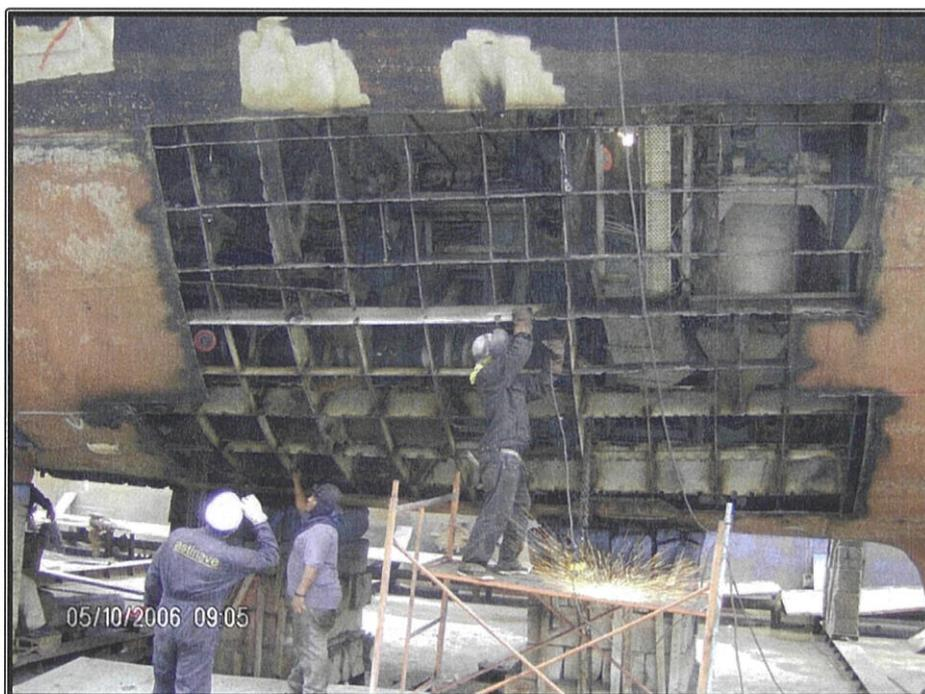
**Figura 40.** Cambio de refuerzos estructurales, [1]
