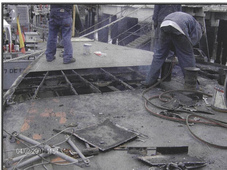
**Figura 38.** Cambio de planchaje en la cubierta principal, [1]
