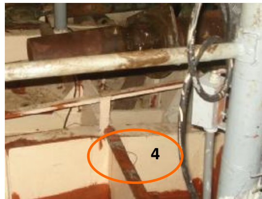
Foto No. 5. b: Extensómetro 4. Ala de la cuaderna 30-babor
