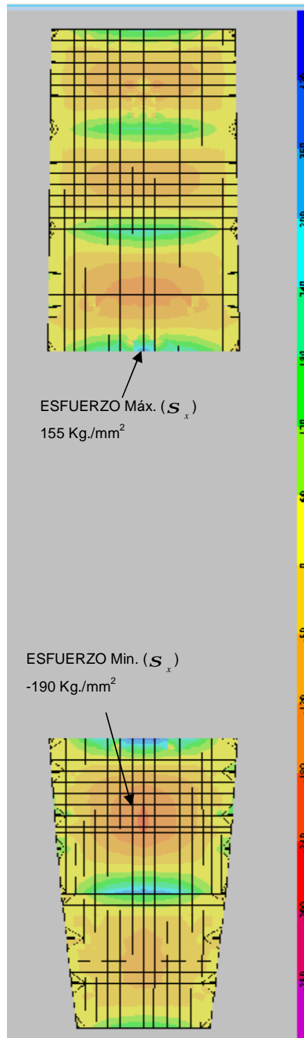
Figura No. 34: Esfuerzos Máximos y Mínimos ( S_x ) de la cubierta Intermedia- Buque Varado
