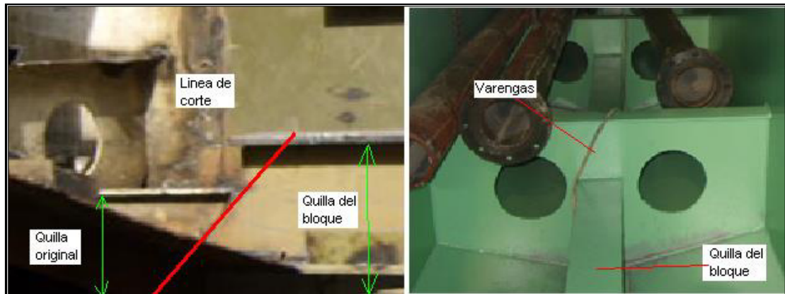
Figura 26.C.- Conexión real de la quilla original con la del bloque añadido.
