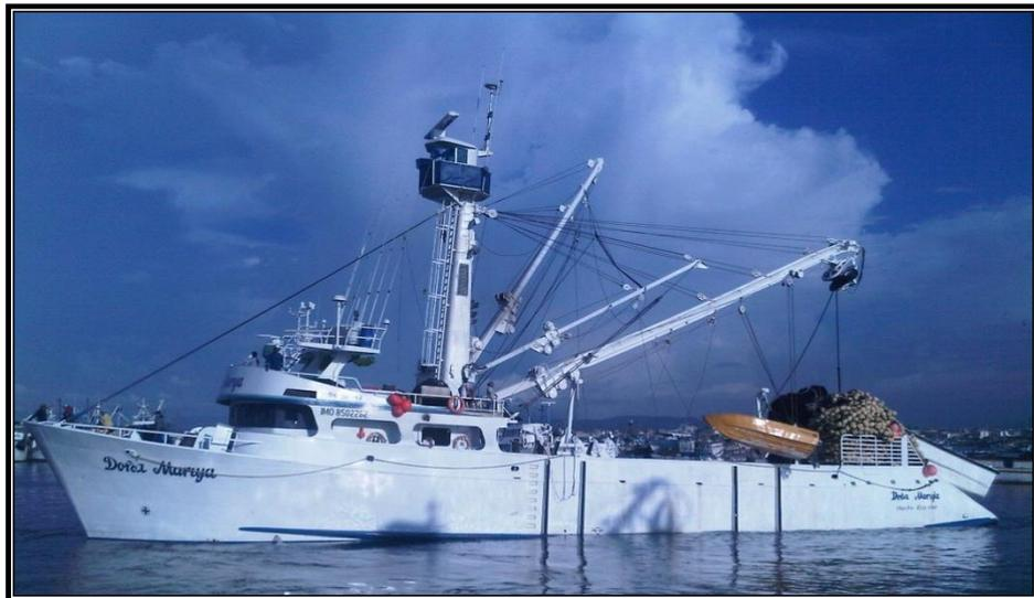
Figura 2.- BP Doña Maruja, en su eslora total después del alargamiento.
