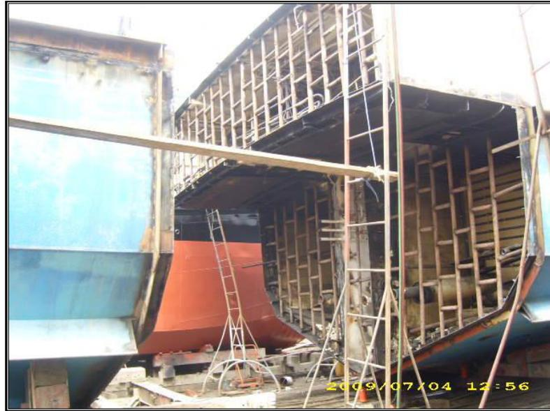
Figura 7.B. Desplazamiento de las mitades, en el área donde se insertó el bloque.
