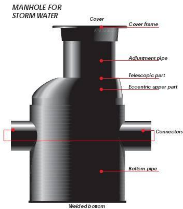
Figura 1.6 Manhole elaborado con tubería de polietileno de pared estructurada.
