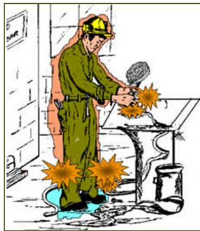
Fig.1 Electrocutación por cables energizados.
