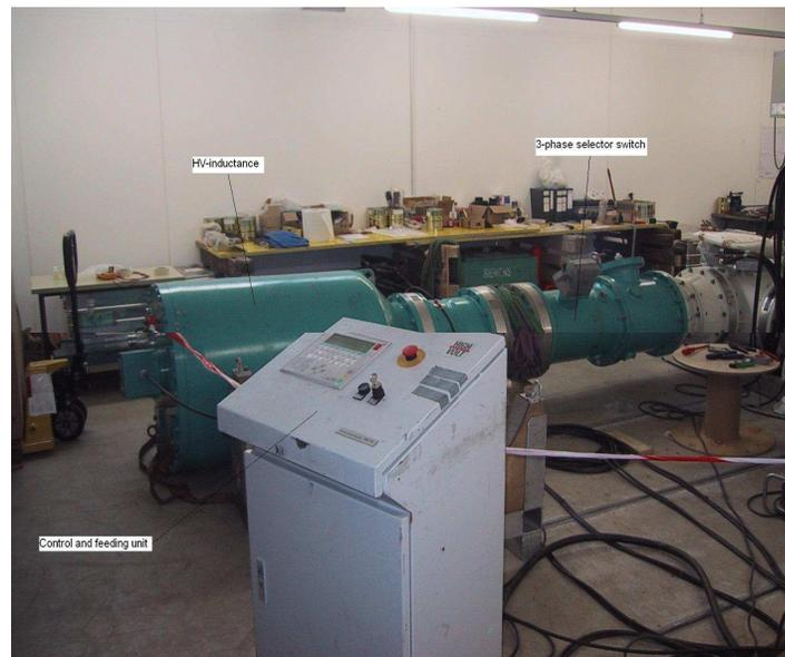
**Fig 25. Equipo para prueba de Alta Tensión**
