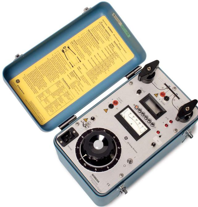
**Fig 18. Microhmetro modelo MOM600A**
