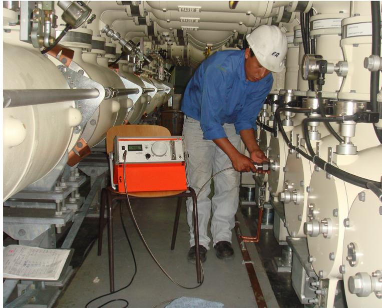
**Fig 21a Equipo de medición de punto de rocío.**
