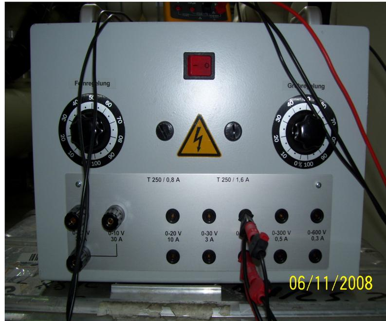
**Fig 20. Equipo de Inyección de corriente.**
