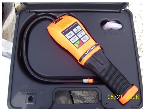
**Fig 28. Detector de Fuga de gas**
