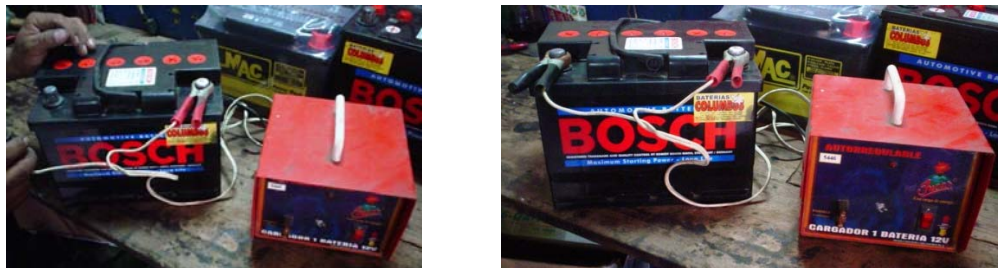
Figura 4.16 Proceso de recargada de Batería.
