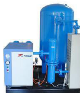
Secador de aire de alta + tanque de aire + filtro de aire
