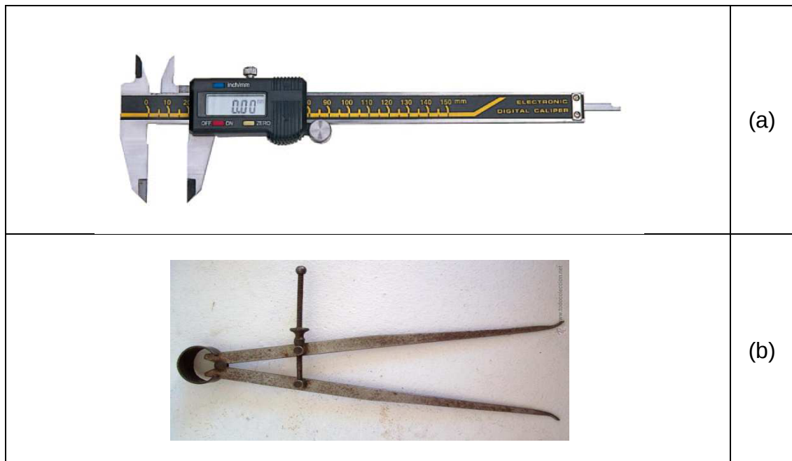
Figura 9.- Herramientas utilizadas para medir los espesores de los tablones
