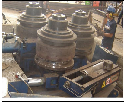
FIGURA 4.16 E3: VIGA CURVA
