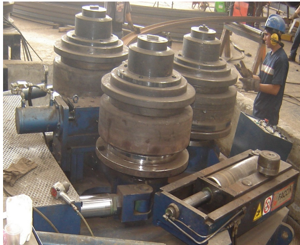
FIGURA 3.5 CURVADO DE VIGAS
