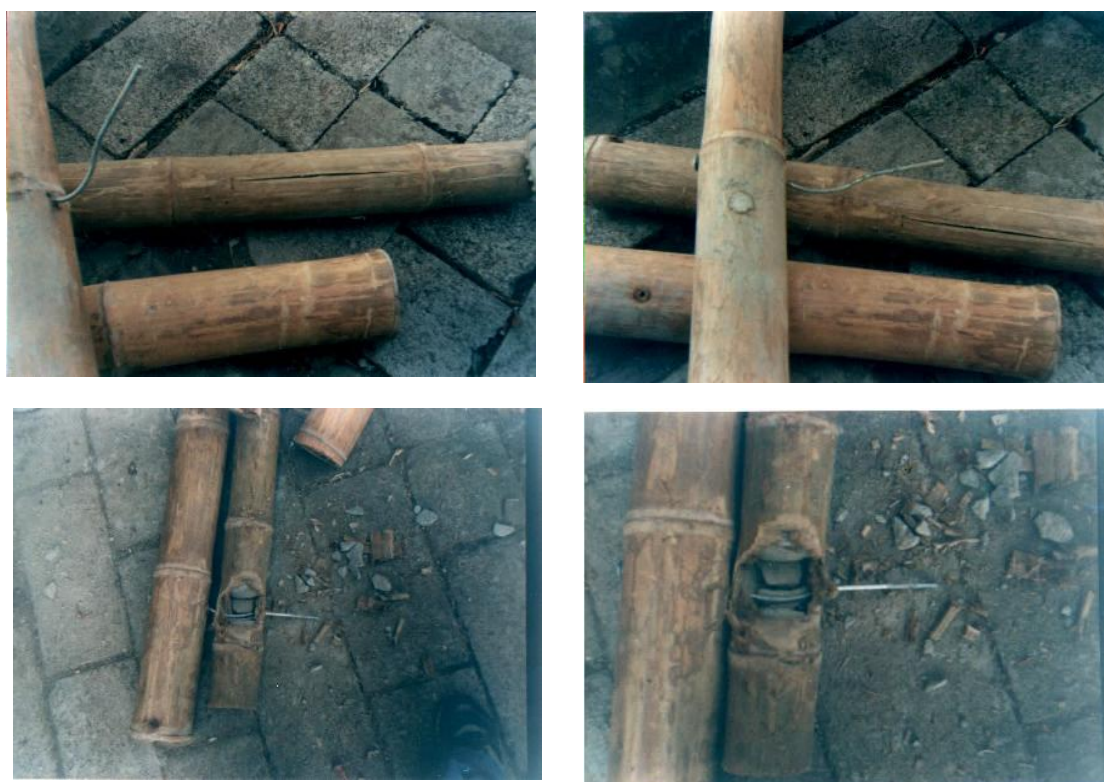
Figura 2.11 Deformación de perno de \frac{1}{4} "
