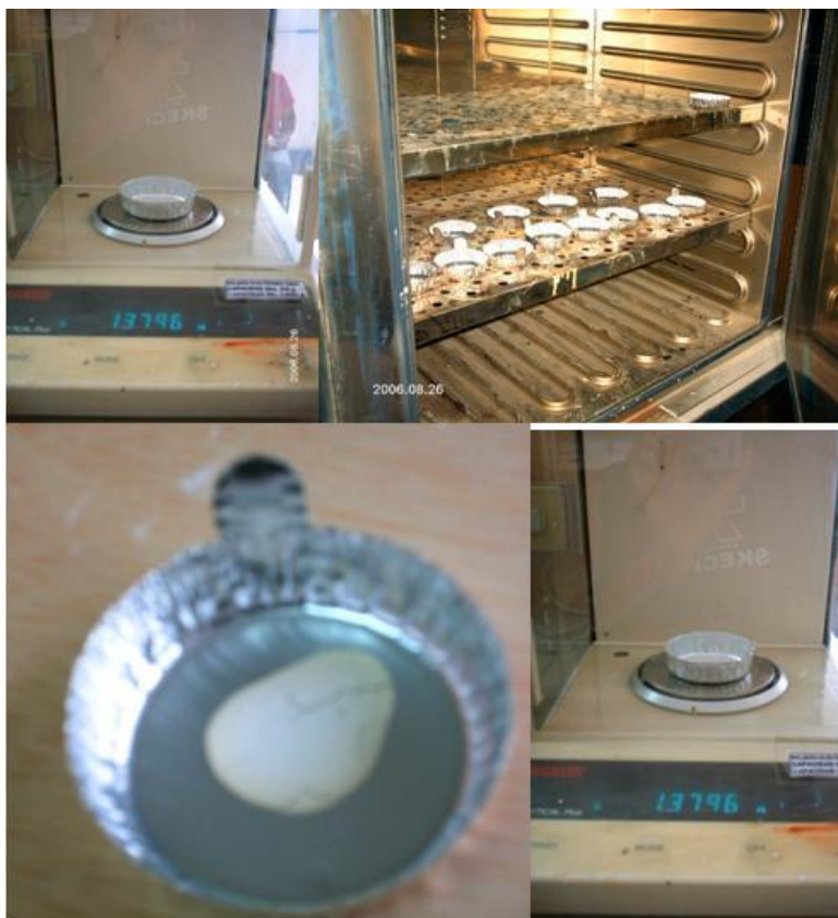
FIGURA 3.22. Medición de porcentaje de sólido.
