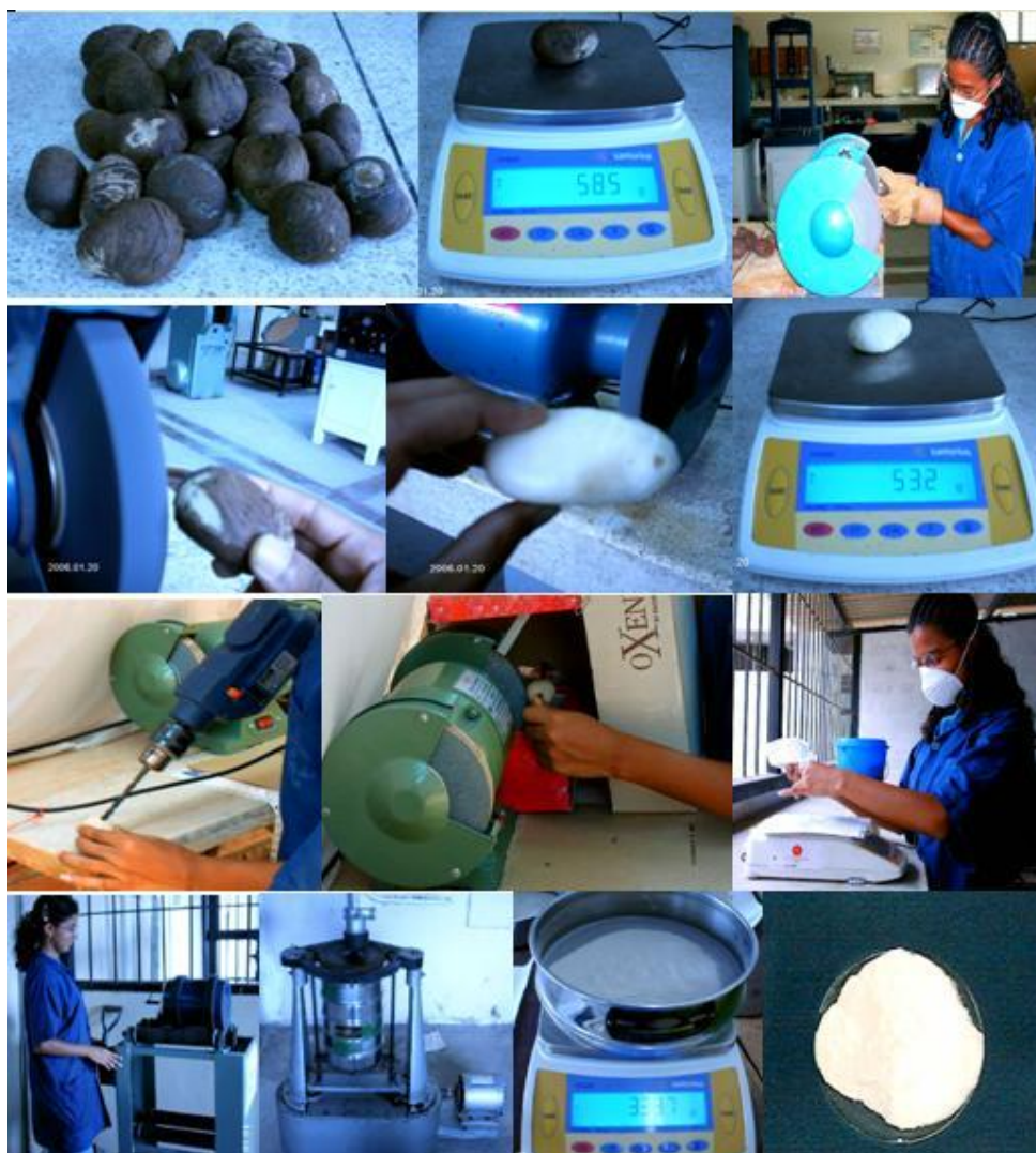
FIGURA 3.1. Proceso de Preparación de la semilla de Tagua.
