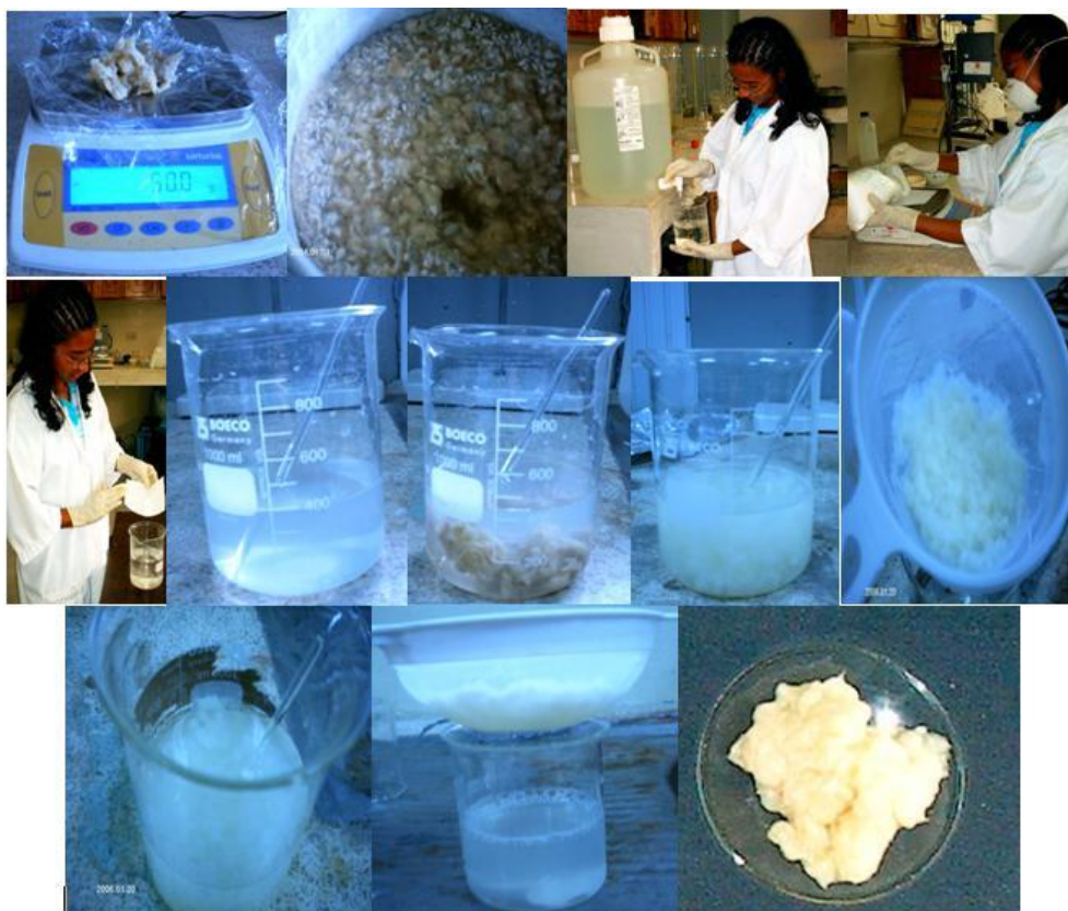
FIGURA 3.4. Proceso de preparación de la fibra de Cabuya por tratamiento de Alcalinización y Blanqueo.
