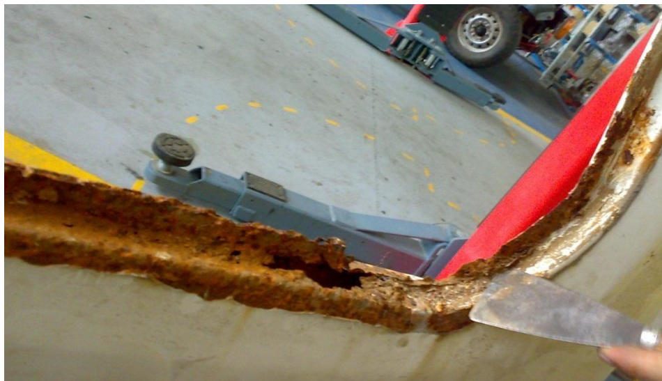
5-6 VENTANA POSTERIOR DETERIORADA
