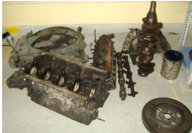
2-1. DESMONTAJE DEL MOTOR
