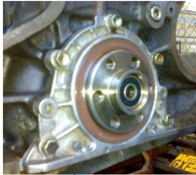
2-11. INSTALACIÓN DEL SELLO DE ACEITE POSTERIOR
