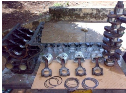
2-5. MONTAJE DE PARTES MÓVILES DEL MOTOR
