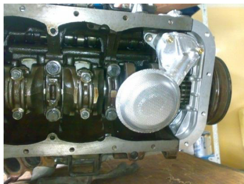
2-12. INSTALACIÓN DE BOMBA DE ACEITE
