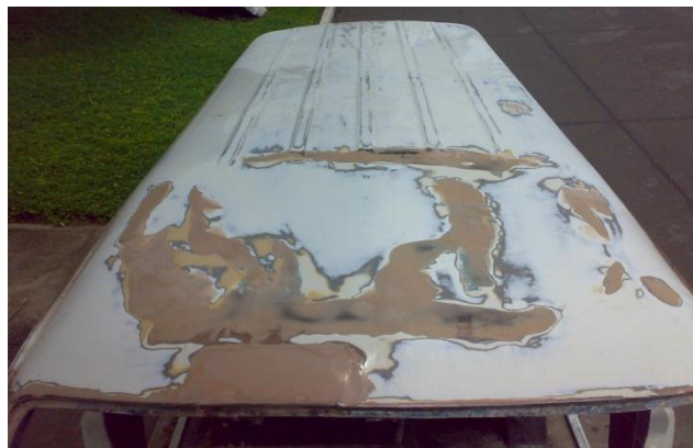
5-8 MASILLADO DE PARTE SUPERIOR DE LA CAMIONETA
