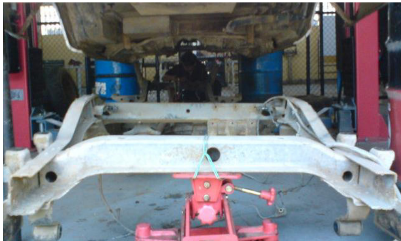
0-7. DESMONTAJE DEL CHASIS
