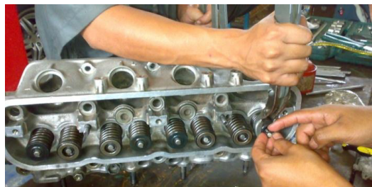
2-8. INSTALACIÓN DE RESORTES Y CHAVETAS DE VÁLVULAS
