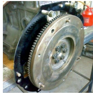
2-10 .INSTALACIÓN DEL VOLANTE DE INERCIA
