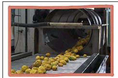
**Figura 3.9** Túnel de lavado
