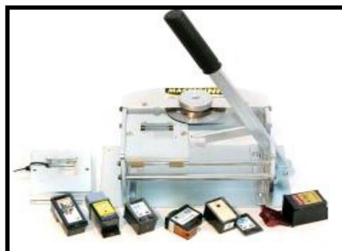
El dispositivo para abrir los cartuchos M10 es usado para abrir los cartuchos obstruidos o con problemas de contaminación en los colores, permitiendo la limpieza interna y la recuperación de carcassas que serían desechados. El uso de este dispositivo en el proceso es opcional todo dependerá del estado del cartucho.
