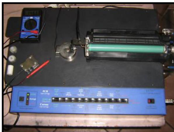
Se realiza una prueba electrónica con el analizador LT-777 para determinar la integridad de cada uno de los componentes del cartucho y su viabilidad para ser reutilizados. El LT-777 es considerado por la industria internacional de la remanufactura como el más avanzado equipo de pruebas y diagnóstico de cartuchos de toner. Se desarma completamente el cartucho y evalúa cada componente, para cambiarlo en caso de ser necesario. Se desechan los componentes que el LT-777 identificó como no confiables.
