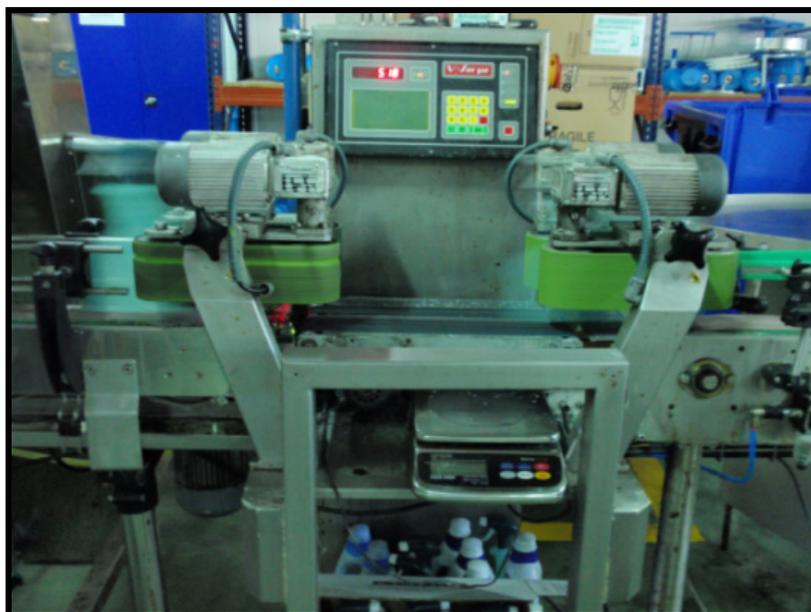
**FIGURA 3.19 BALANZA DINAMICA**
