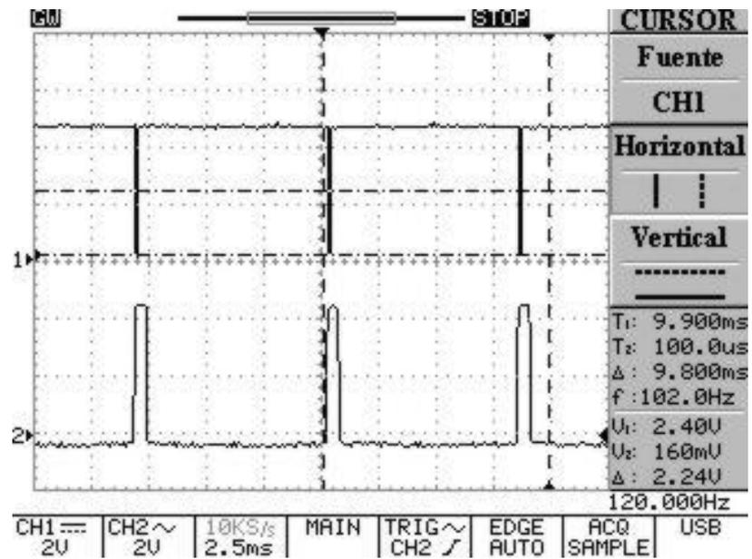
Fig. 4.15 Modulación PWM para un foco totalmente encendido
