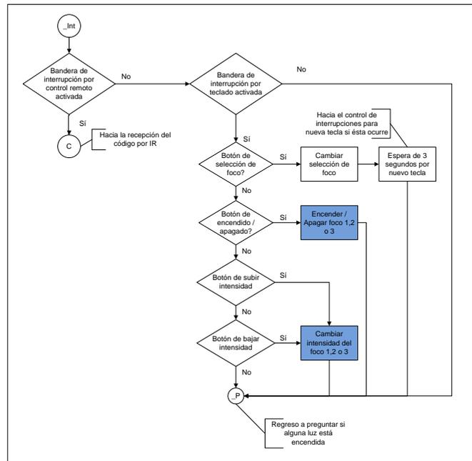
Fig. 3.7 Algoritmo de respuesta a interrupción del teclado
