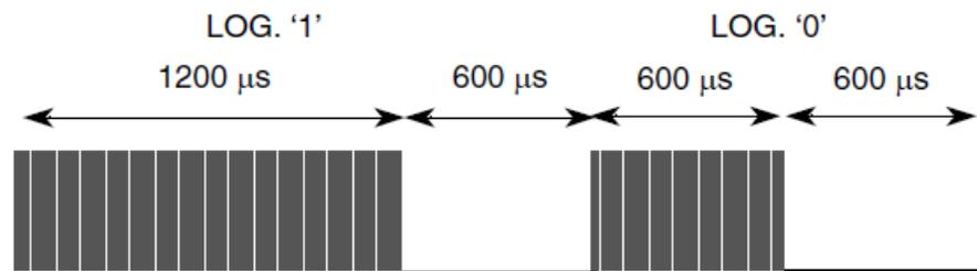
Fig. 2.17 Codificación de bit del protocolo SIRC
