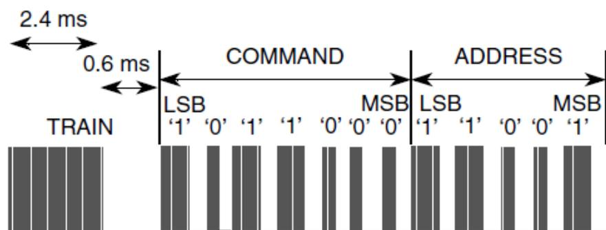
Fig. 2.18 Estructura de la trama del protocolo SIRC
