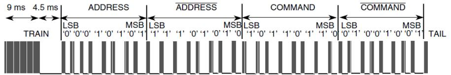
Fig. 2.3 Estructura de la trama de datos del protocolo NEC
