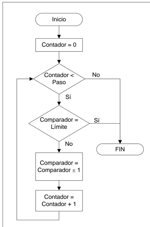
Fig. 3.12 Algoritmo de aumento/disminución de un paso
