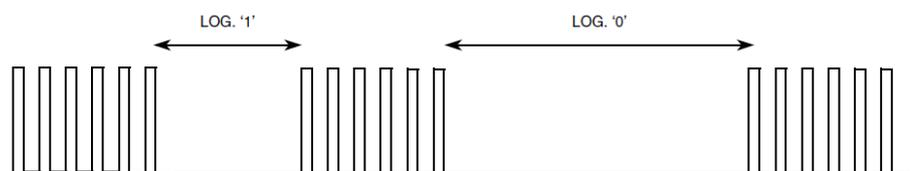
Fig. 2.1 Codificación por distancia entre pulsos
