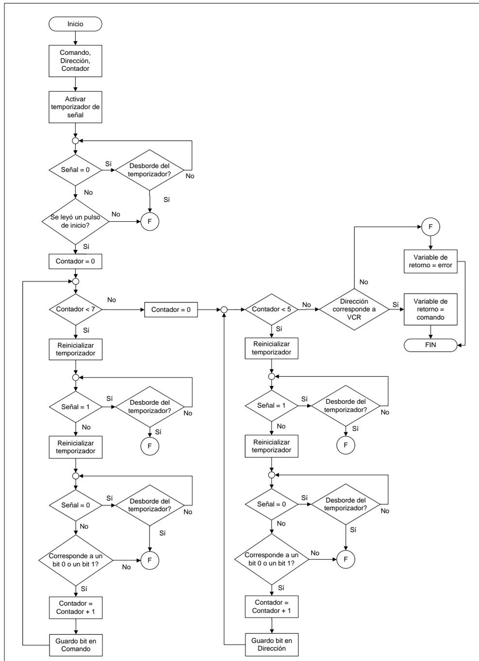
Fig. 3.13 Algoritmo de decodificación de las señales del protocolo SIRC
