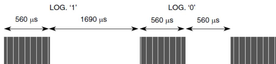
Fig. 2.2 Codificación de bit del protocolo NEC
