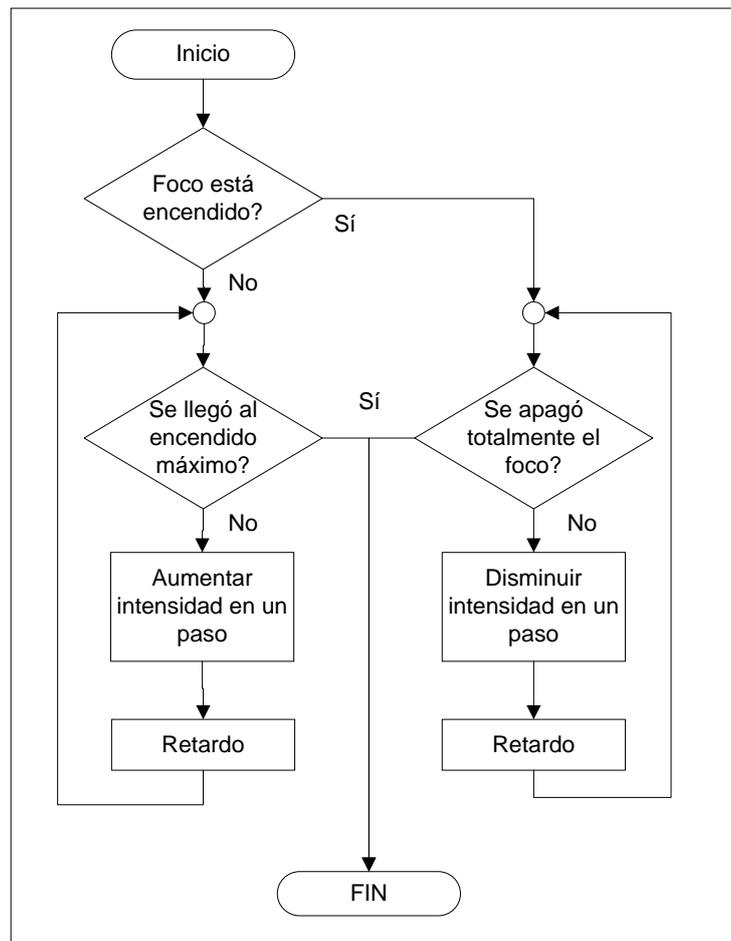
Fig. 3.14 Algoritmo de encendido/apagado de una luz
