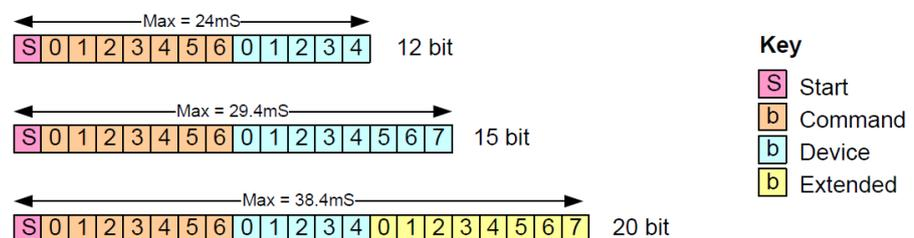
Fig. 2.16 Versiones del protocolo SIRC
