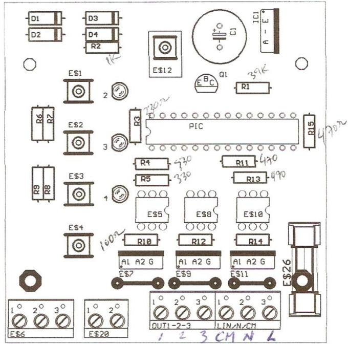
Fig B.2. Diagrama del circuito impreso
