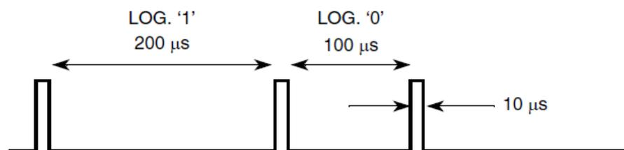
Fig. 2.13 Codificación de bit del protocolo ITT
