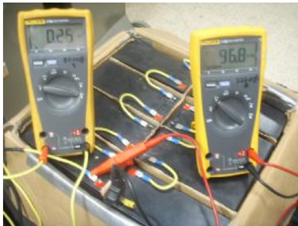
Figura 10: Corriente y Voltaje en el lado DC
