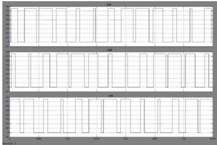
FIGURA 3.14 Voltajes Modulados Generados ( V_{aN} , V_{bN} y V_{cN} )
