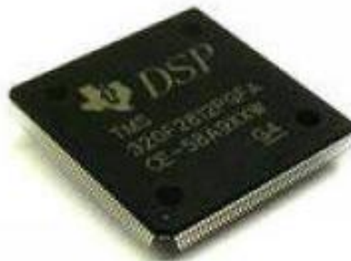
FIGURA 4.3 Foto del DSP TMS320F2812
