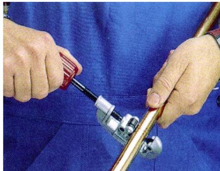
Figura 4.15 Corte del tubo (22)
