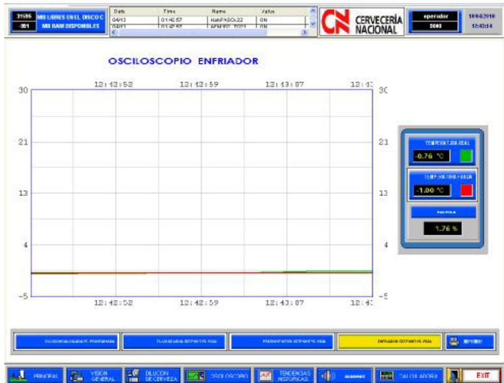
Figura 5.49.- Curvas Temperatura fijada Vs Temperatura Real, con un PID ya sintonizado.
