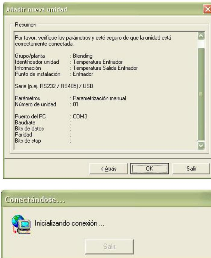
**Figura 3.50.- Ventana de estado de comunicación del transmisor.**
