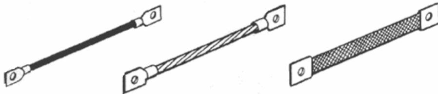
**FIGURA 7. Cables puentes de unión.**
