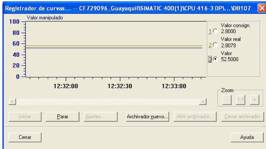
Figura 5.41.- Curvas que muestran la estabilización del controlador PID para el ingreso de CO2.
