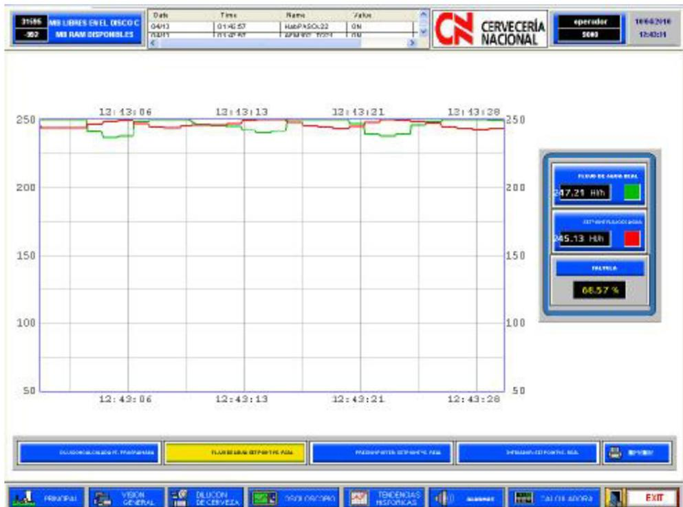
**Figura 5.50.- Curvas Set Point de Flujo de Agua Vs Flujo de Agua Real, con un PID ya sintonizado.**
