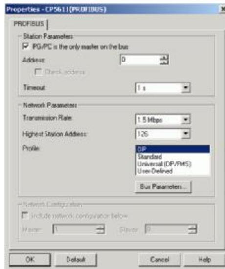
**Figura 5.9.- Configuración de la tarjeta PCMCIA CP 5512.**
