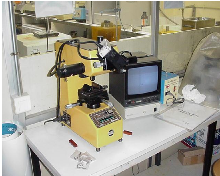
FIGURA #7 Microdurómetro Digital Utilizado en la Determinación de la Dureza de las Muestras de Aluminio (99.87%)
