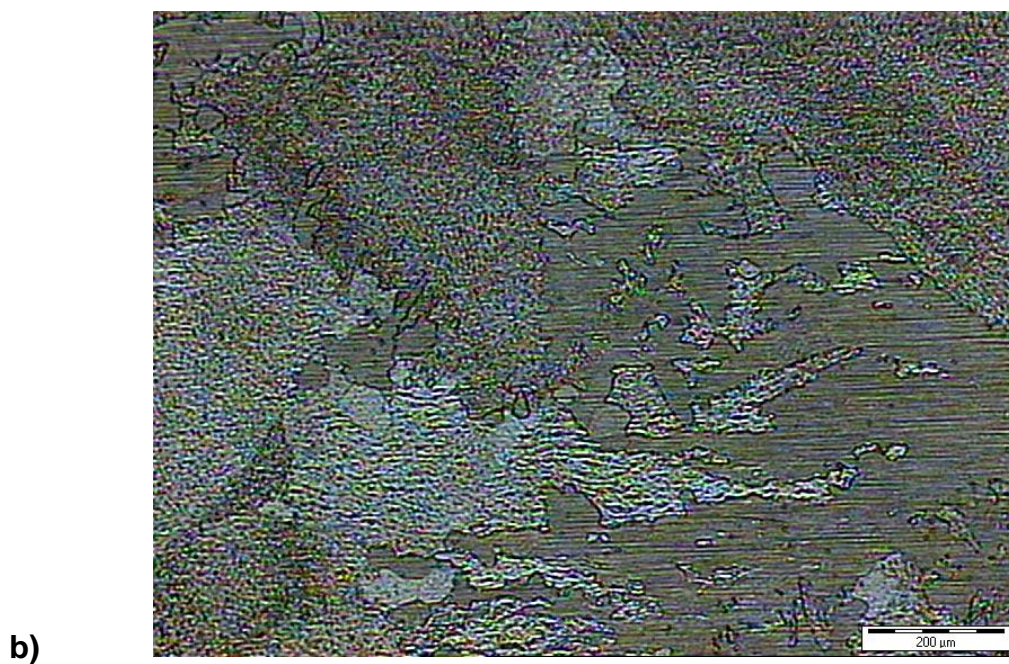
FIGURA # 9 Fotomicrografías de las Muestras Previo Tratamiento Térmico de Recocido a 300°C y Enfriada a Temperatura Ambiente a) Sección Longitudinal, b) Sección Transversal; (X500)
