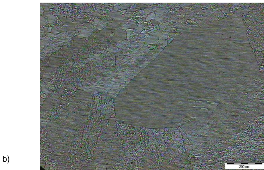
FIGURA #8 Fotomicrografías de las Muestras Previo Tratamiento Térmico de Recocido a 250°C y Enfriada a Temperatura Ambiente a) Sección Longitudinal, b) Sección Transversal; (X500)
