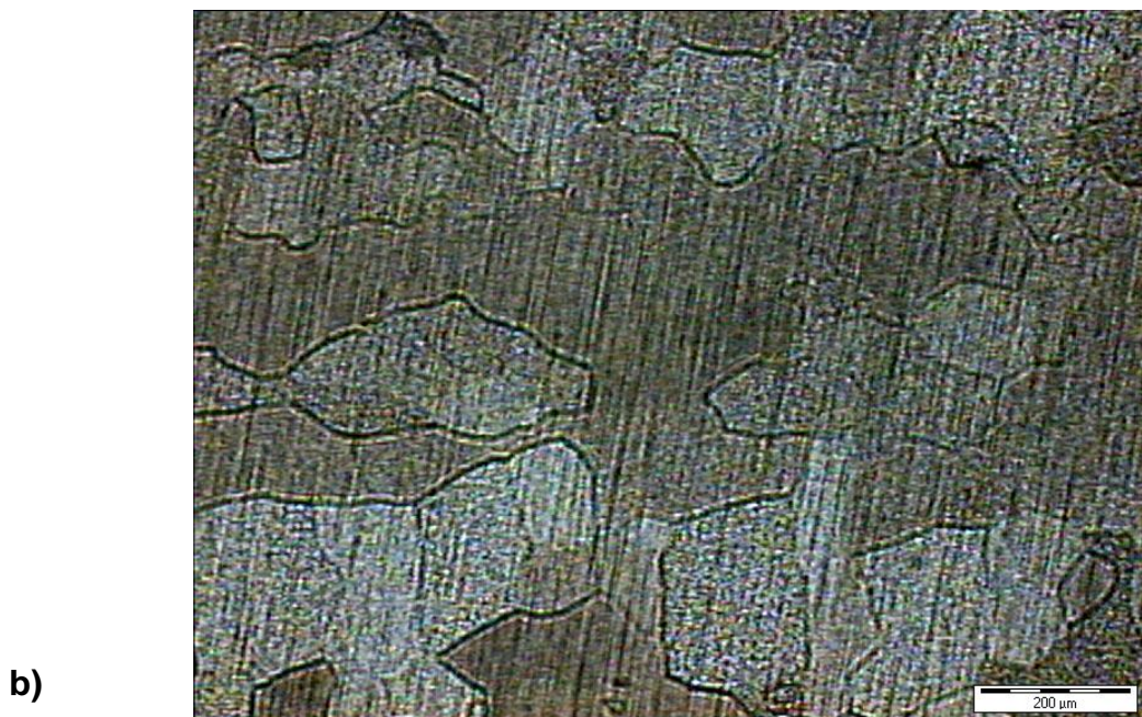
FIGURA #10 Fotomicrograffías de las Muestras Previo Tratamiento Térmico de Recocido a 350°C y Enfriadas a Temperatura Ambiente a) Sección Longitudinal, b) Sección Transversal; (X500)
