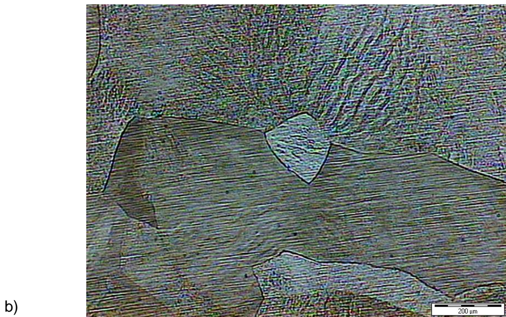
FIGURA #17 Fotomicrografías de las Muestras Previo Proceso de Termoconformado a 300°C y a Velocidad de Deformación de 0.1\text{s}^{-1} a) Sección Longitudinal b) Sección Transversal (X500)
