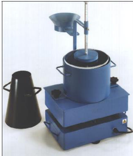
Fotografía 1. Consistómetro Vebe, descrito en ACI 211.3.
