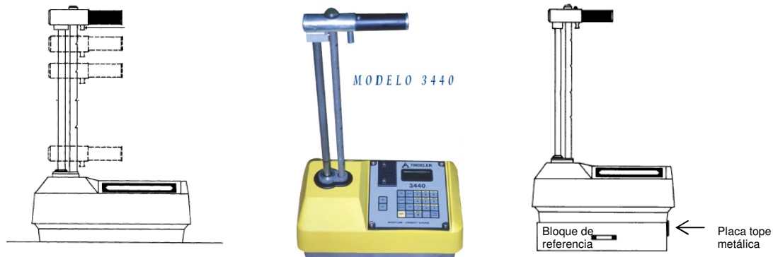
Figura 20.- Foto y Esquema de Densímetro Nuclear TROXLER 3440
