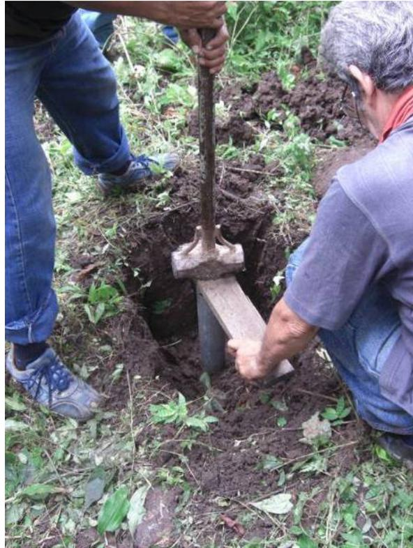
Figura 7.- toma de muestras de suelo arcilloso utilizando tubo chelvy
