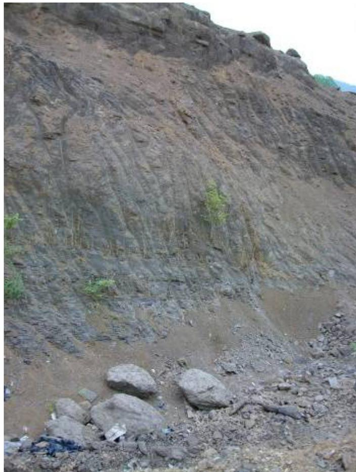
Figura 4.- Areniscas y Micro conglomerado poco meteorizado, donde se puedan obtener material de enrocado.
