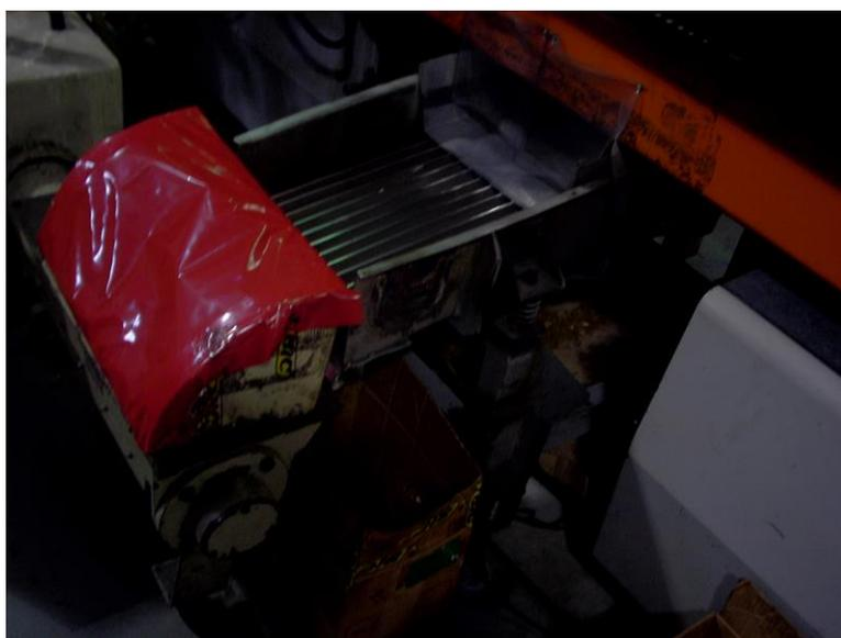
**FIGURA 3.5** MOLINO GRANULADOR COLOCADO AL PIE DE LA INYECTORA
