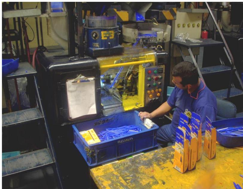
**FIGURA 1.14 ENSAMBLADORA DE BOLÍGRAFOS Y EMPAQUE**
