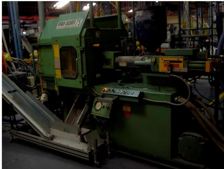
**FIGURA 1.12 INYECTORA DE BOTÓN**
