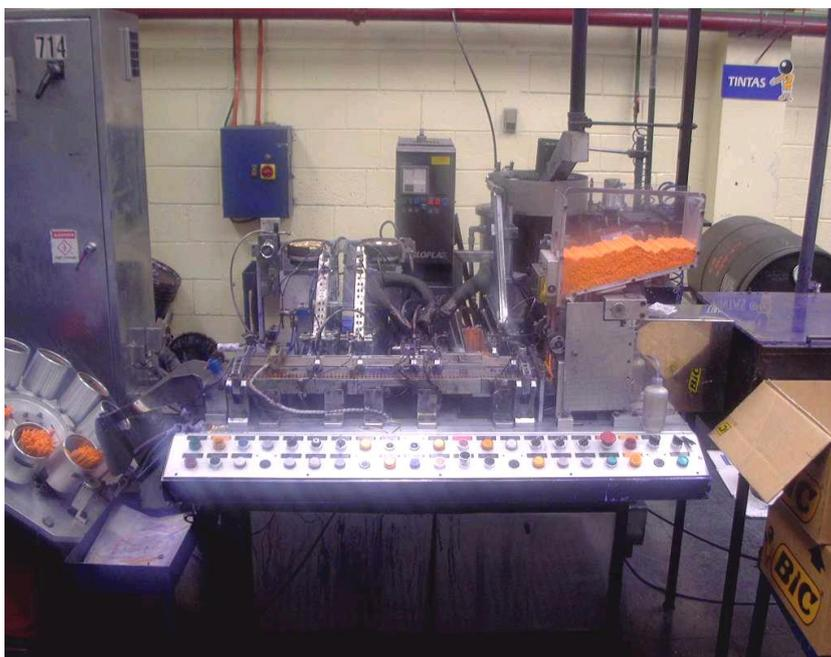
**FIGURA 1.13 MÁQUINA ENSAMBLADORA DE REPUESTOS**
