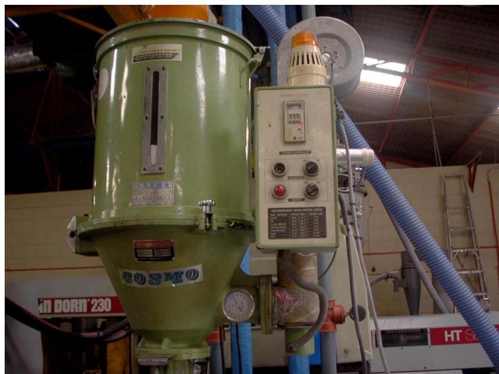
**FIGURA 2.2 SECADOR DE AIRE CALIENTE DE LA PLANTA DE
