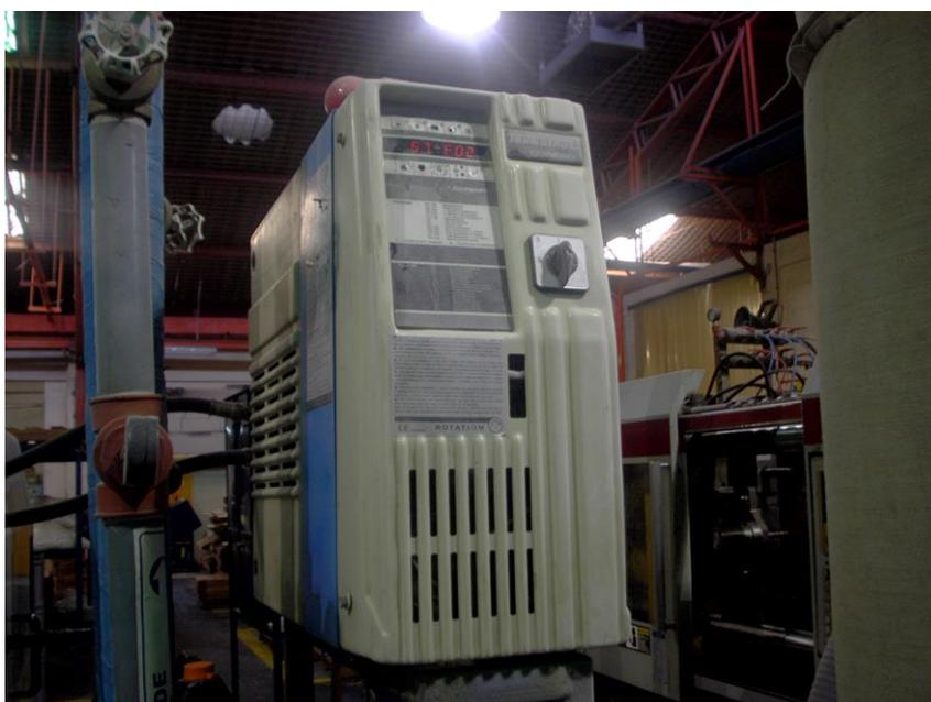
**FIGURA 3.3 CALENTADOR DEL MOLDE DE SOPORTES**
