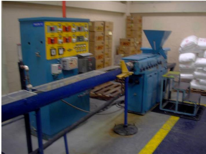
**FIGURA 1.5 EXTRUSORA DE TUBO CONTENEDOR DE TINTA**
