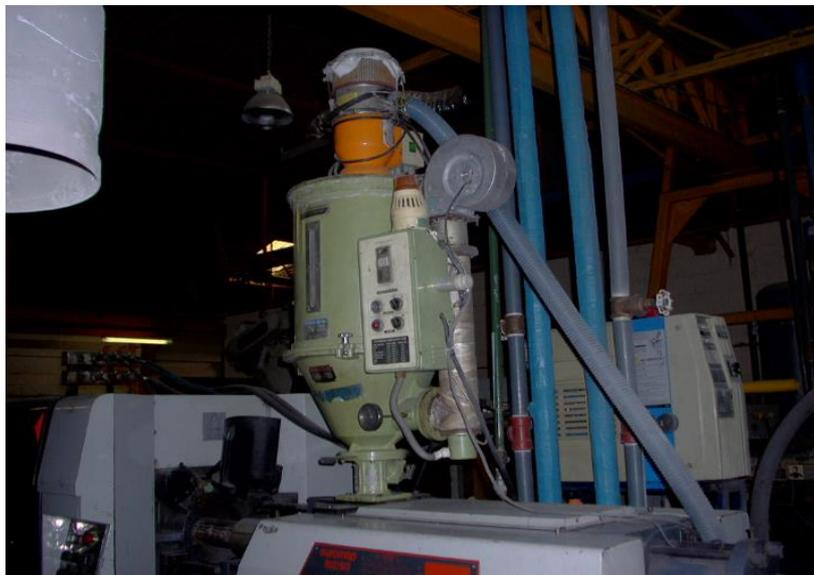
**FIGURA 2.4 SECADOR INSTALADO SOBRE LA ALIMENTACIÓN DE LA INYECTORA**
