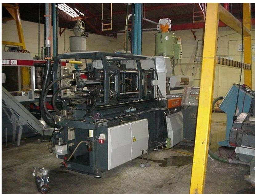
**FIGURA 3.1 INYECTORA DE SOPORTES CON SECADOR
