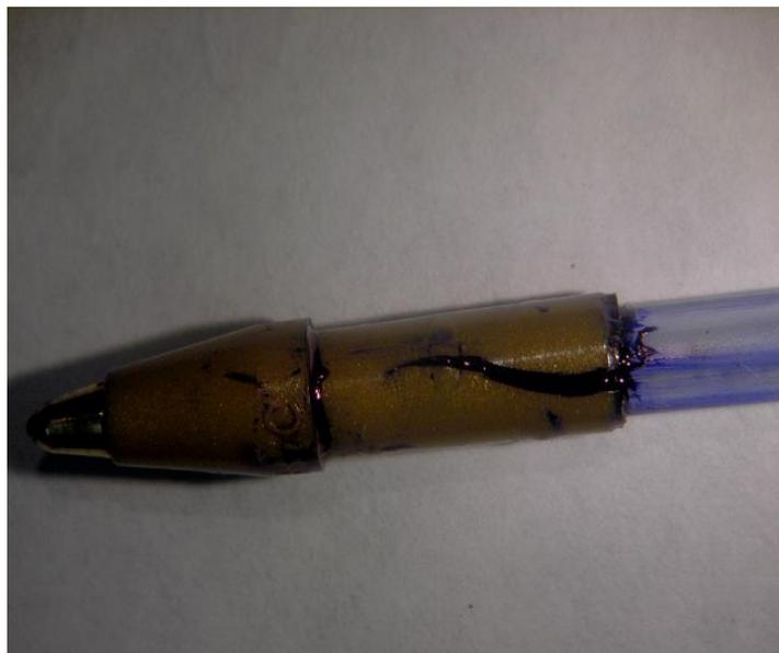
**FIGURA 1.19 FRACTURA TÍPICA PRESENTADA EN SUBENSAMBLE AL MOMENTO DE INTRODUCIR EL TUBO EN EL SOPORTE**
