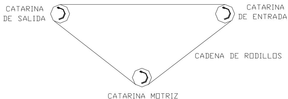
FIG.3.15. TRASMISION DE LA CADENA DE RODILLOS
