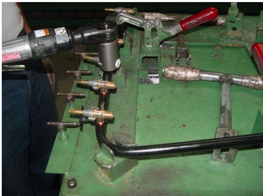
Figura 3.1 ENSAMBLE DE TUBO DE VALVULAS Y VALVULAS.
