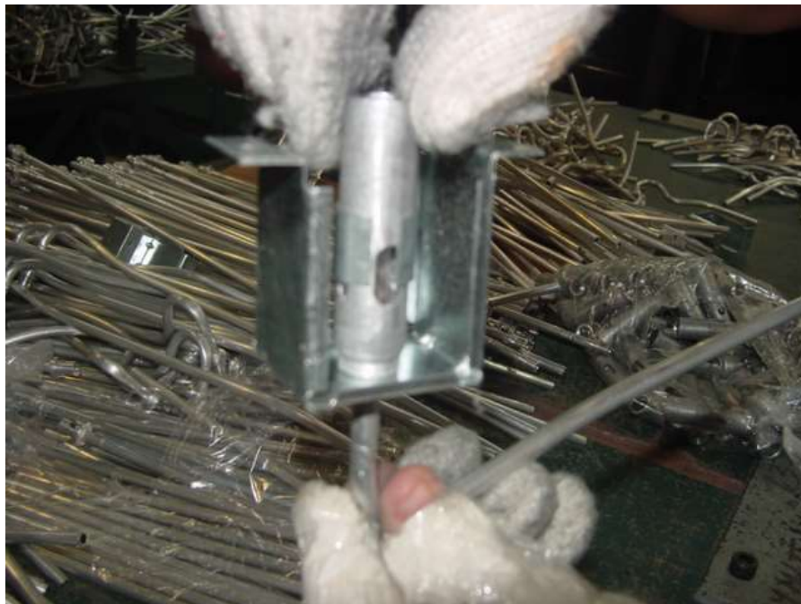
FIGURA 3.2 ENSAMBLE DEL SOPORTE REGULADOR Y TUBERIA DE ALUMINIO.
