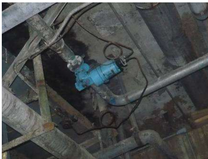
FIGURA 2.21 VÁLVULA PARA REGULACIÓN DE CONSISTENCIA PARA ALIMENTACIÓN DEL REFINADOR DE FIBRA CORTA
