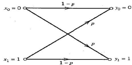
**Problema:** Se desea transmitir datos a la velocidad de 9600 bps sobre un canal RF que tiene una anchura de banda de 19.2 KHz. Cuál es el  $E_b/N_0$  requerido para tener una confiabilidad de un error o menos en  $10^5$  bits transmitidos.
