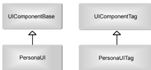
Figura 3.1: Diagrama de clase para el componente de prueba Persona
