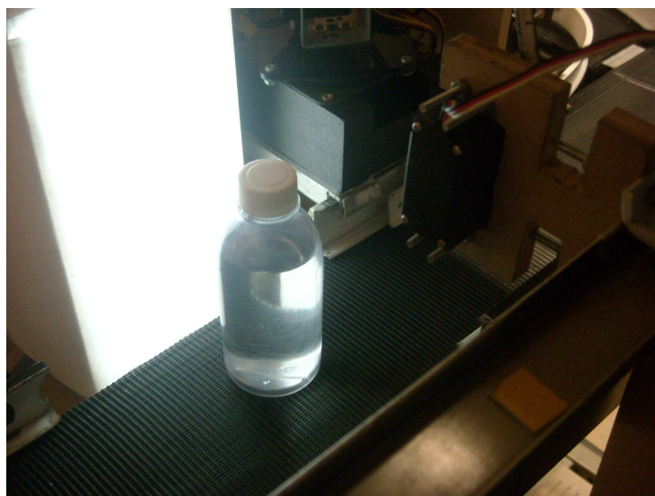
Imagen 4-12 Sistema de iluminación interno
