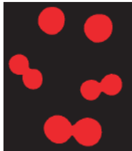
Imagen 2-53 Paso 1: segmentación por umbral (21)
