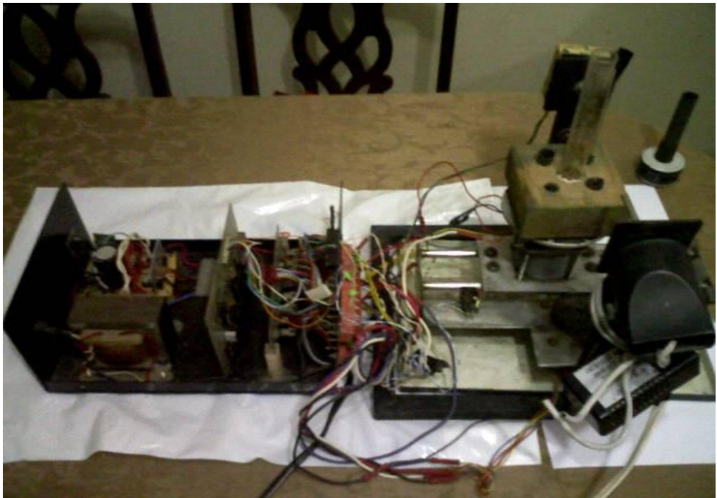
Figura 3.1. Fotografía del tomógrafo construido anteriormente.
