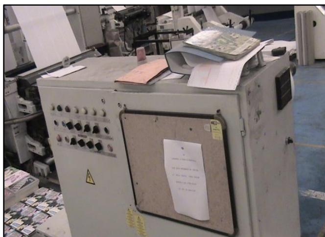
FIGURA 5.14: PANEL DE CONTROL ELÉCTRICO UTILIZADO COMO REPISA (ANTES).
