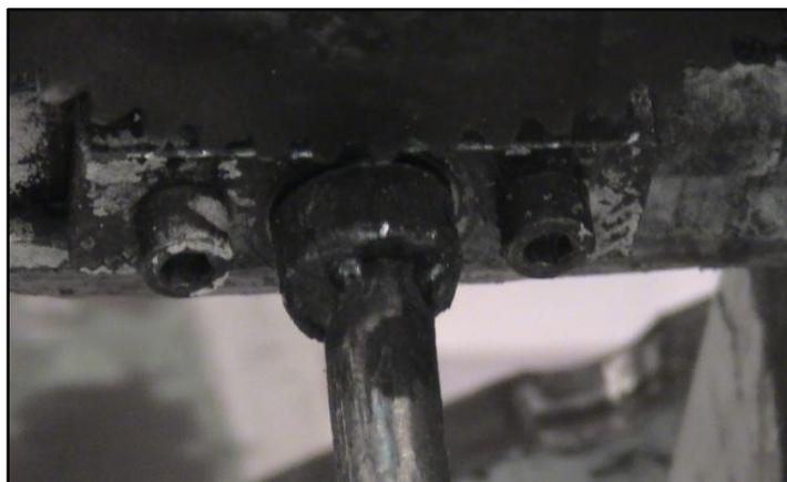
FIGURA 5.8: ALINEADOR DE BOBINA CON DEFECTO (PIEZA SOLDADA)(ANTES).
