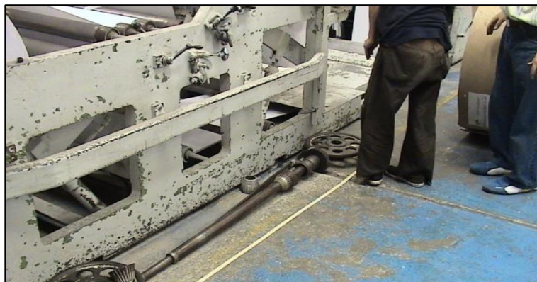
FIGURA 5.7: NO EXISTE UN LUGAR FIJO PARA UBICACIÓN DE EJES Y VOLANTES (ANTES)
