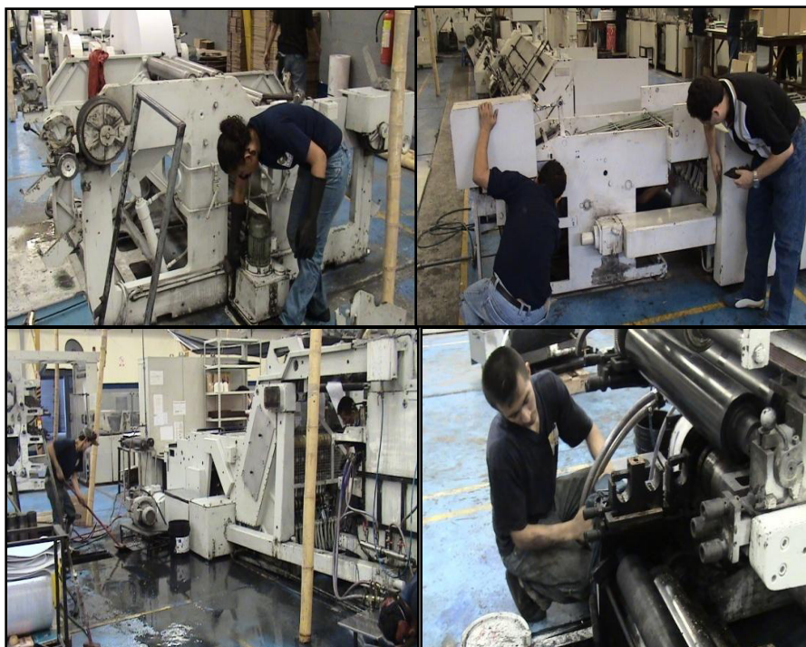
FIGURA 4.22: APLICACIÓN DEL TERCER PILAR (LIMPIEZA)
