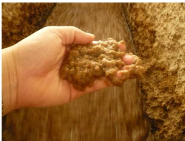
FIGURA 2.18 MUESTRA DE LA FIBRA CORTA REFINADA QUE DESCARGA AL TANQUE DE MÁQUINA.
