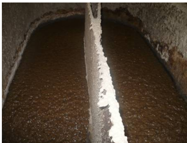
FIGURA 2.17 PASO DE LA FIBRA CORTA REFINADA A TRAVÉS DEL CAJÓN DE NIVEL CONSTANTE
