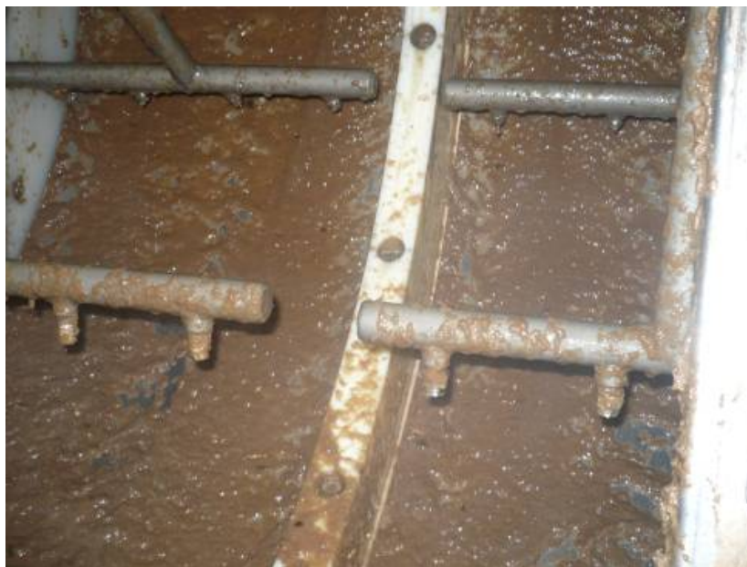
FIGURA 2.16 PASO DE LA PASTA DE PAPEL A TRAVÉS DEL ESPESADOR.
