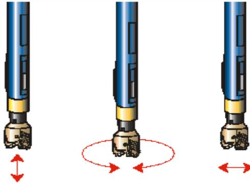
**FIGURA 3.35 VIBRACION AXIAL, VIBRACION TORSIONAL Y VIBRACION LATERAL**
