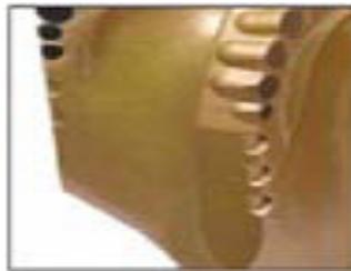
**FIGURA 3.30 CORTADORES EN ALMOHADILLAS DE CALIBRE**
