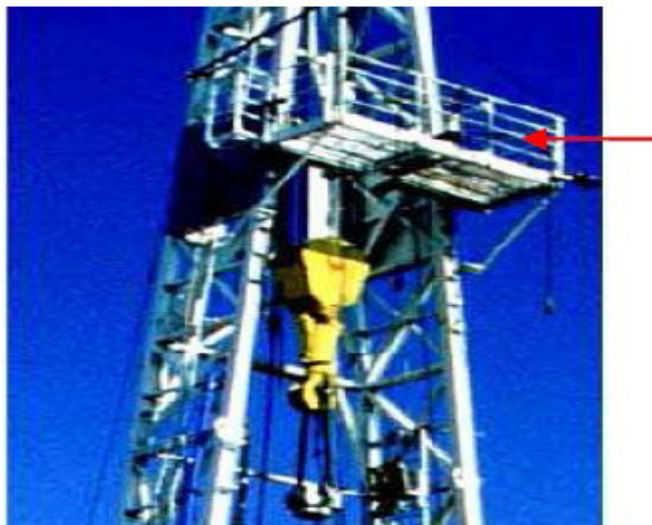
Fig 1.1.1.6 Plataforma del Encuellador
