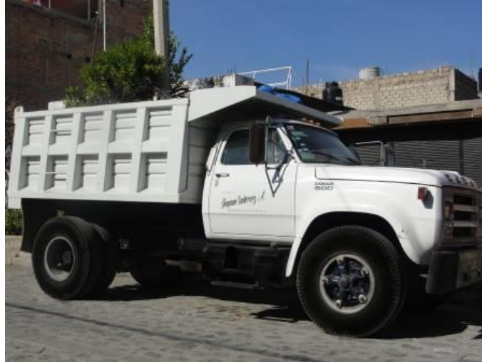
Figura 3.17.- Camión Normal capacidad de 7 metros cúbicos
