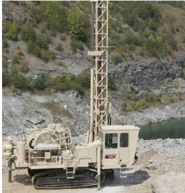
Figura 3.33.- Perforadora para Voladura Atlas Copco, DM25-SP
