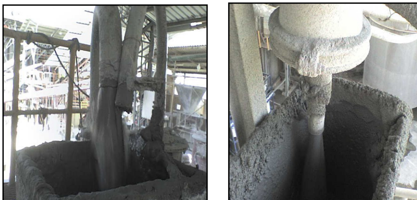
Foto N° 4.3.3.1 Depósitos de Rebose y Descarga
