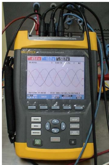
Fig. 4.39 Foto del analizador de energía trifásico FLUKE 435.
