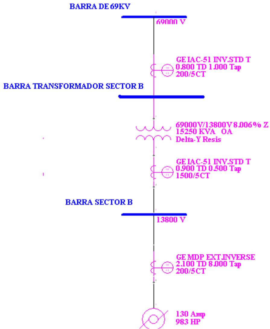
Figura 4.6 Esquema de Protección del Sector B
