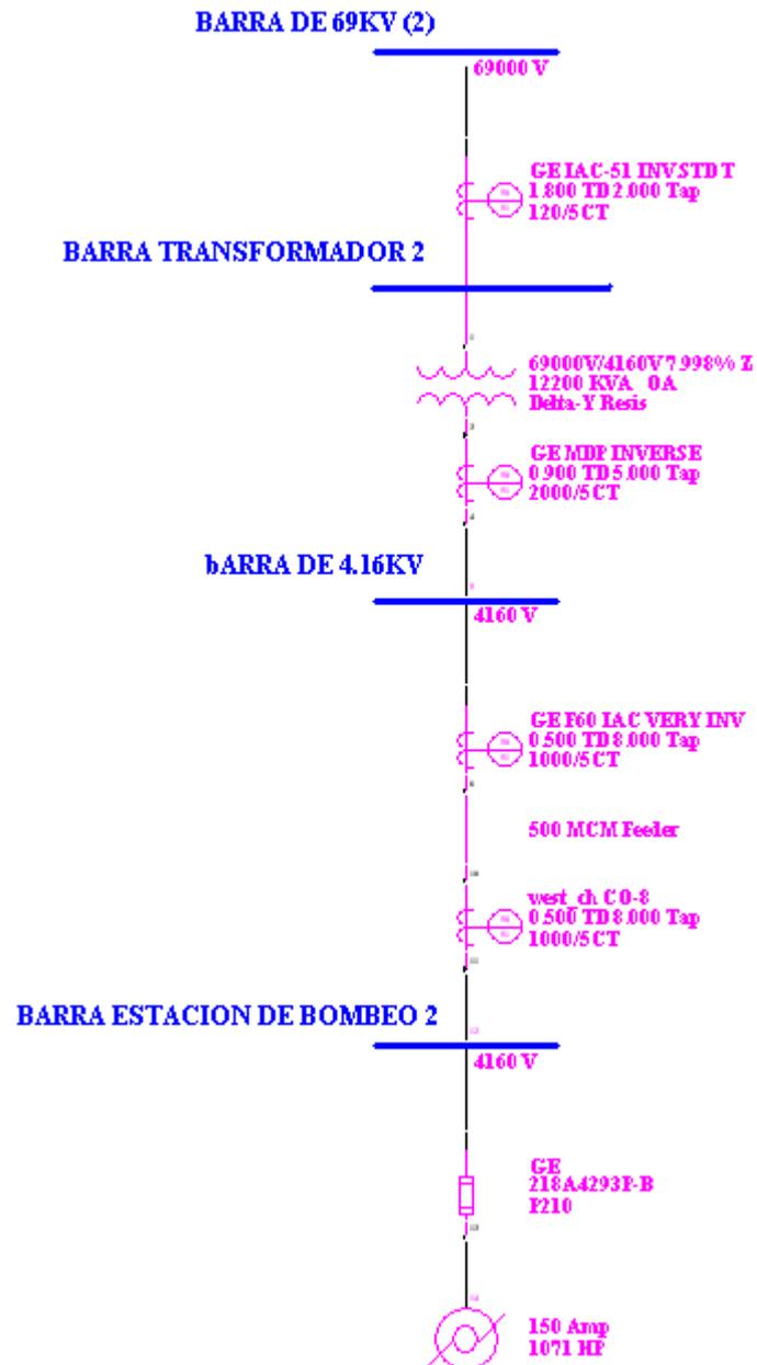
Figura 4.12 Esquema de Protección Estación de Bombeo 2 (EB2)
