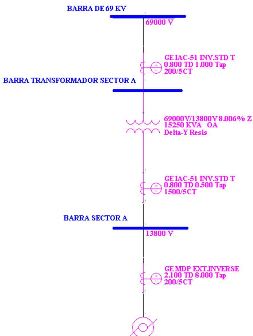
Figura 4.4 Esquema de Protección del Sector A
