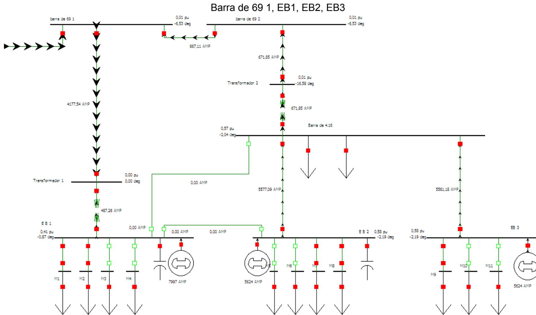
Anexo 4.22 Corrientes con falla L - T en barra transformador 1
