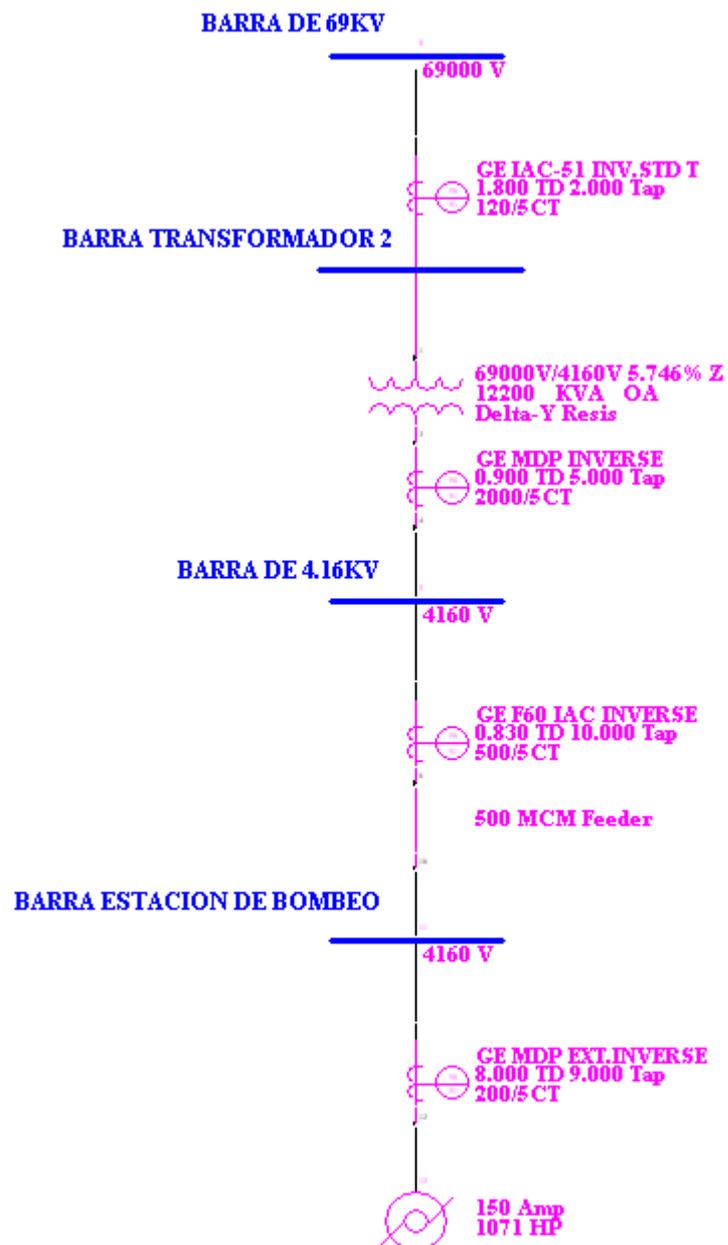
Figura 4.14 Esquema de Protección Estación de Bombeo 3 (EB3)
