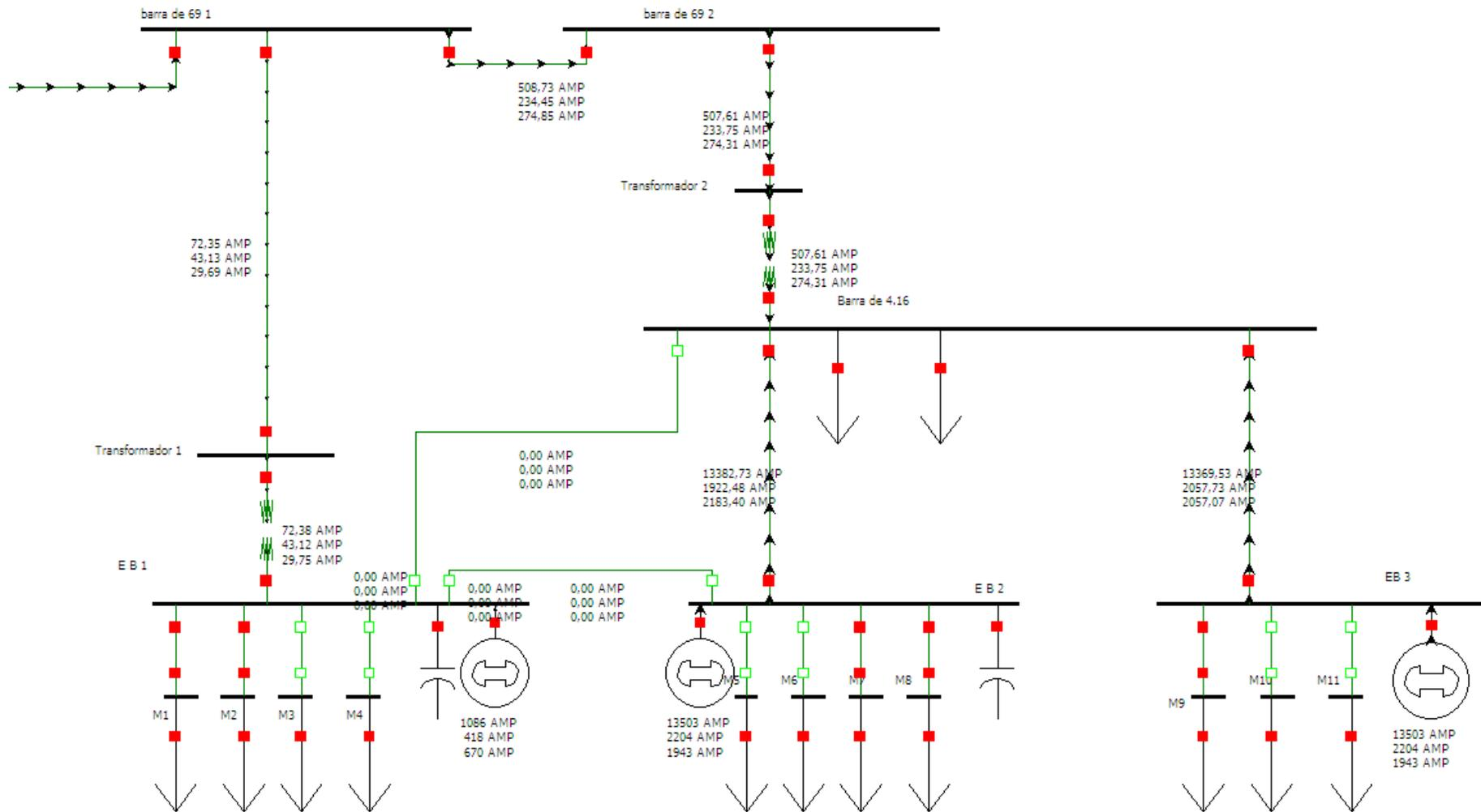
Anexo 4.21 Corrientes con falla trifásica en barra transformador 1
