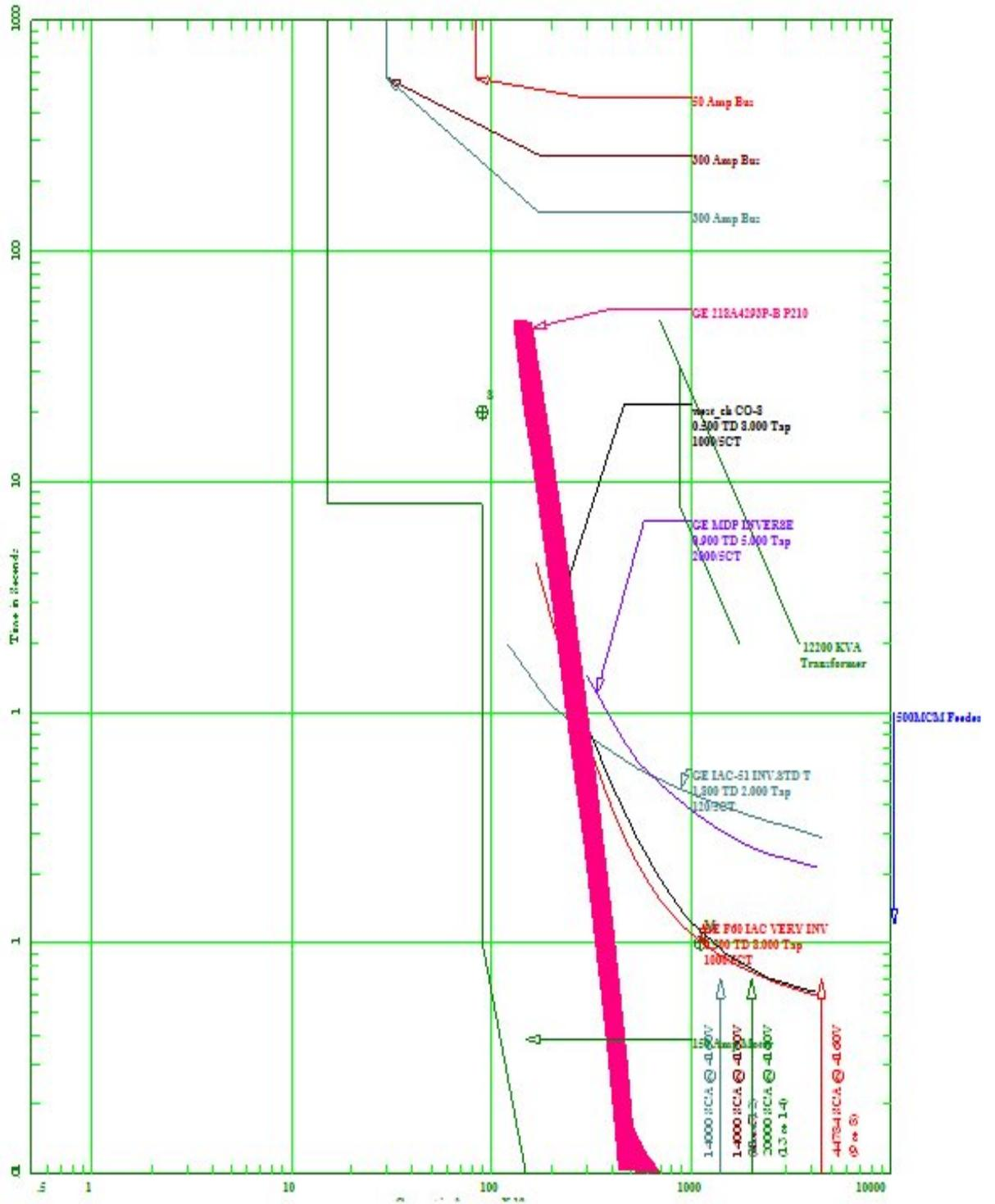
Figura 4.13 Coordinación Relés de Sobrecorriente (Estación de Bombeo 2)
