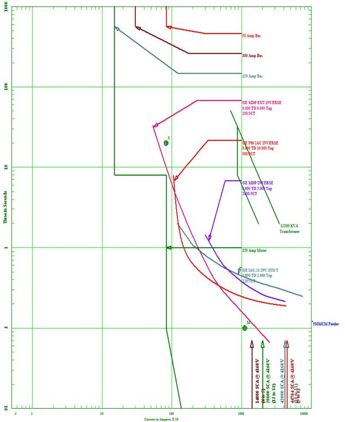
Figura 4.15 Coordinación Relés de Sobrecorriente (Estación de Bombeo 3)
