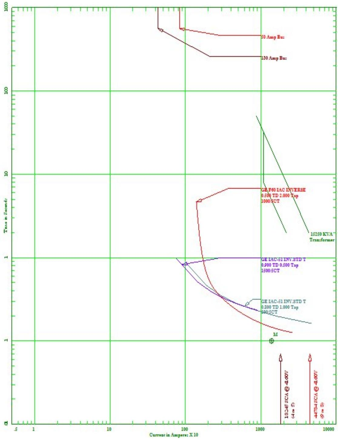
Figura 4.9 Coordinación Relés de Sobrecorriente (Planta Tratamiento)
