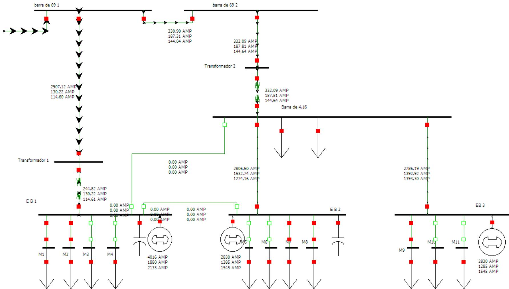
Anexo 4.23 Corrientes con falla trifásica en barra transformador 2
