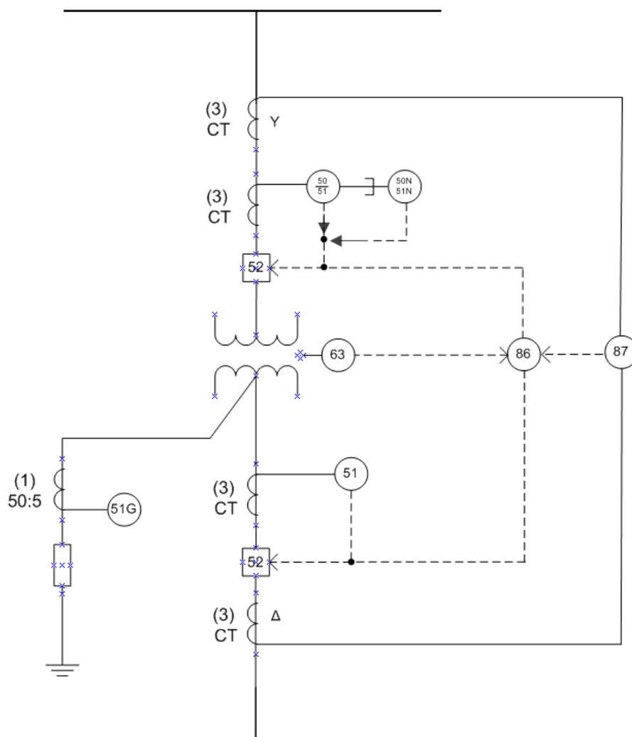
Figura 4.1 Esquema de Protección de Transformadores
