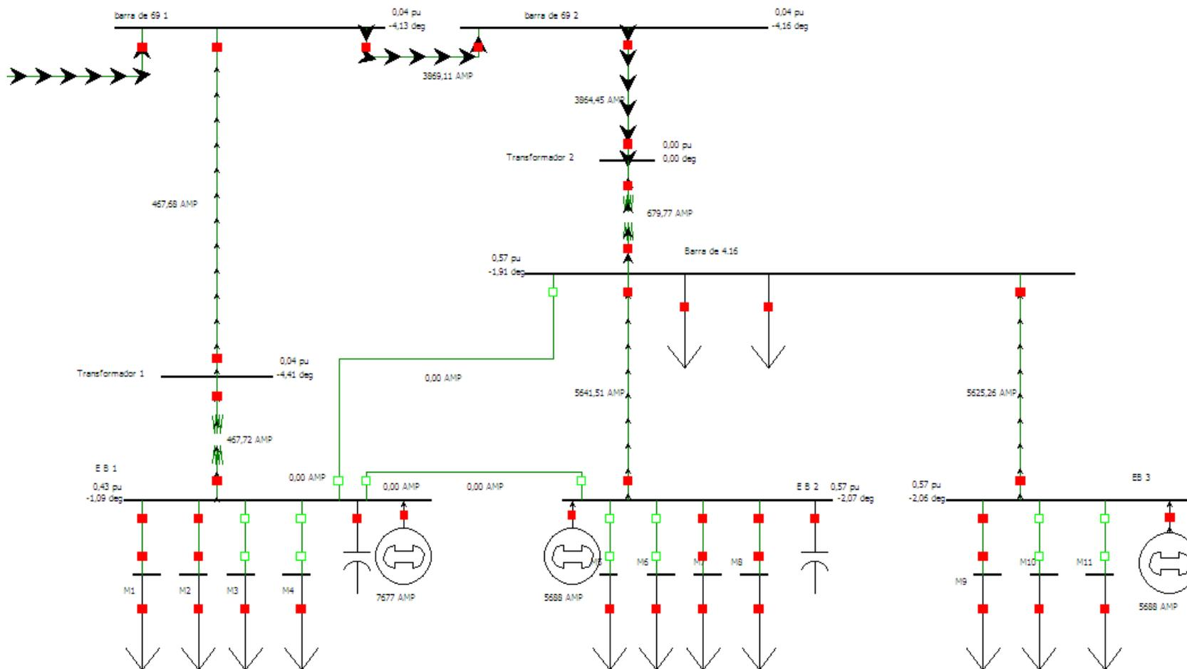
Anexo 4.24 Corrientes con falla L – T en barra transformador 2
