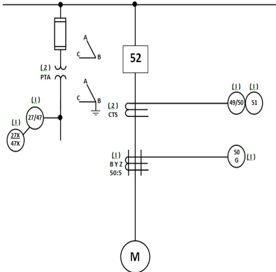
Figura 4.2 Protección de Motores menores de 1500HP
