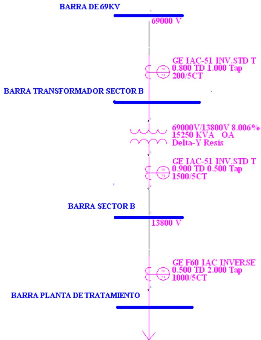
Figura 4.8 Esquema de Protección Planta de Tratamiento
