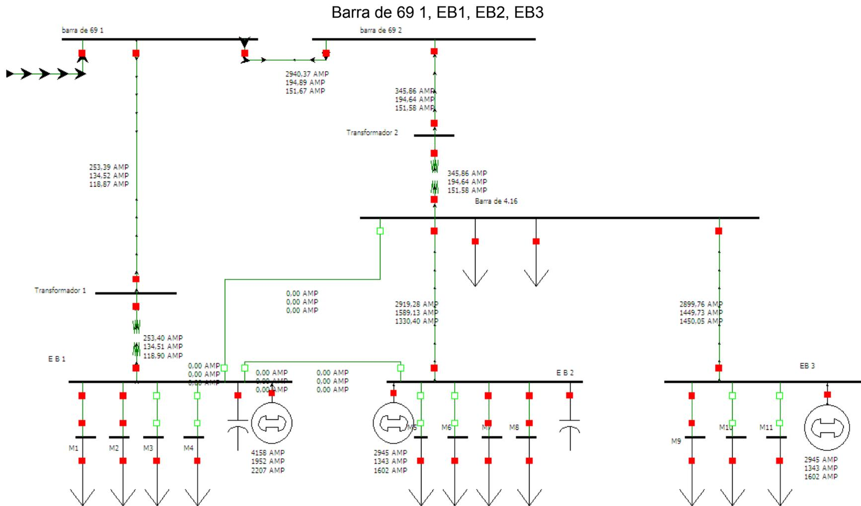
**Anexo 4.29 Corrientes con falla trifásica en motor 1250HP en EB 1**
