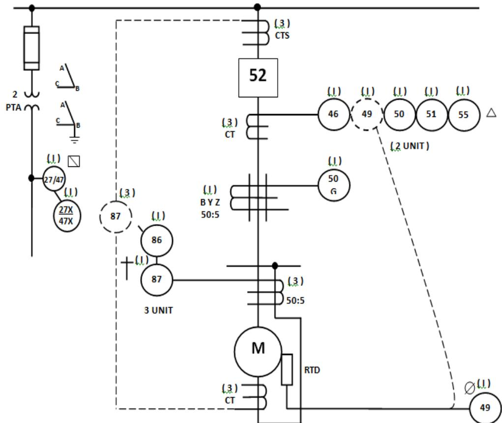
Figura 4.3 Protección de Motores mayores de 1500HP
