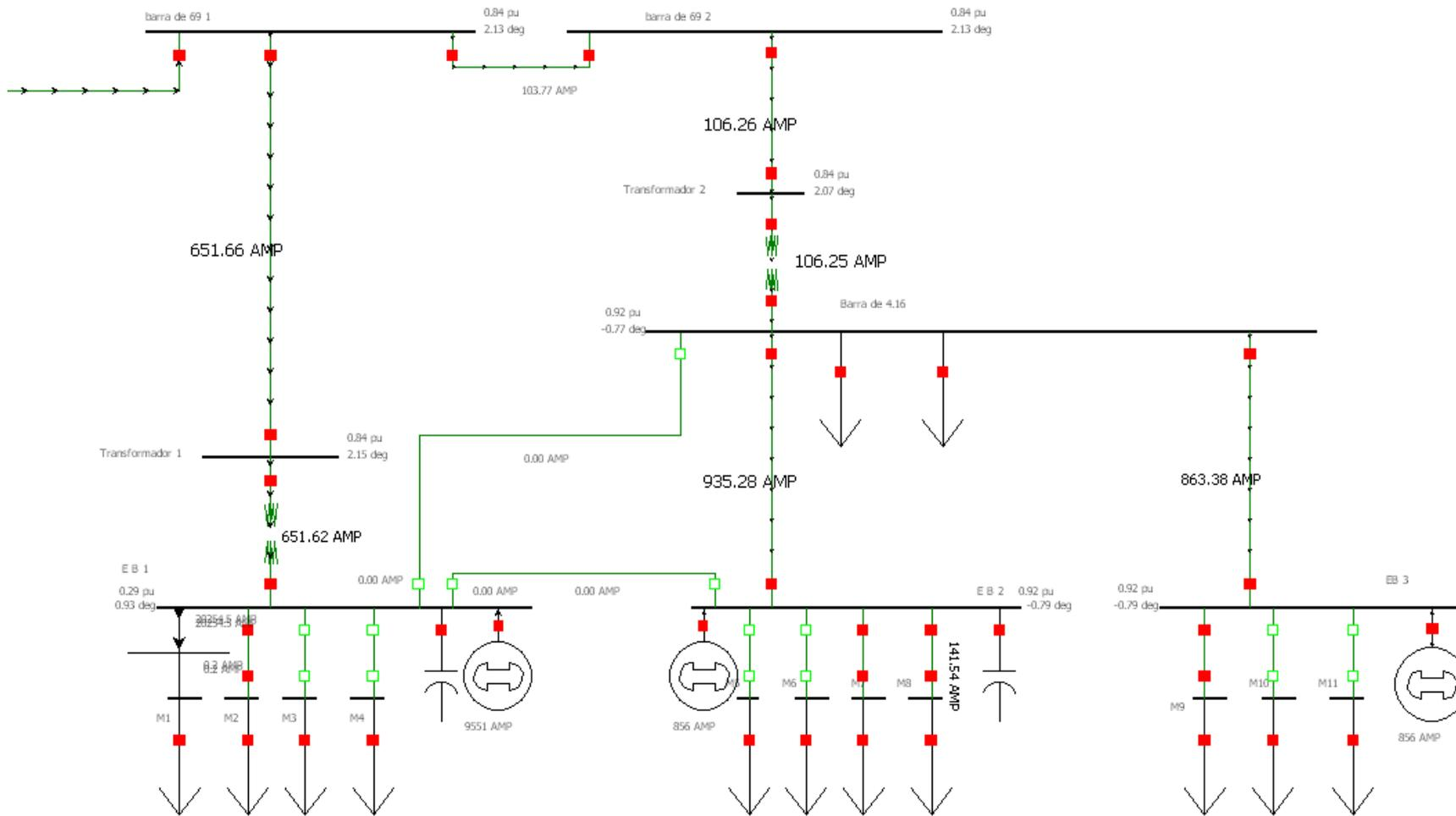
**Anexo 4.30 Corrientes con falla trifásica en motor 1250HP en EB 2**
