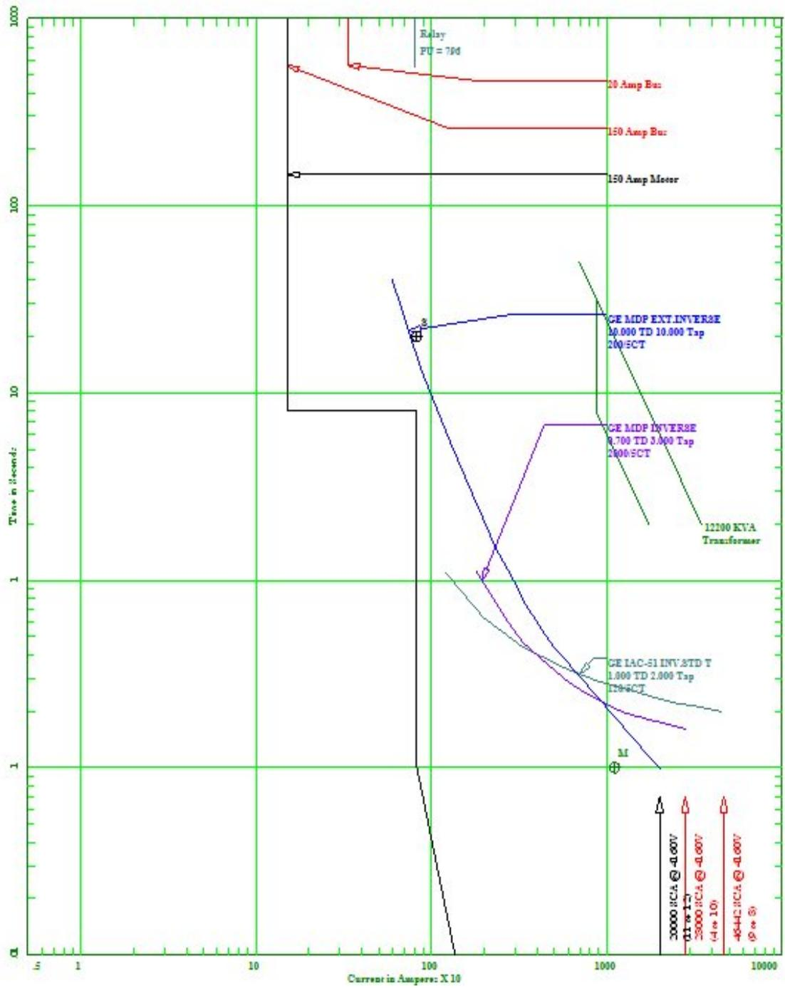
Figura 4.11 Coordinación Relés de Sobrecorriente (Estación de Bombeo1)
