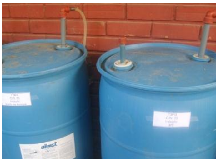
Fotografía 9. Biodigestores limpios, cerrados herméticamente y debidamente identificados en pleno proceso.
