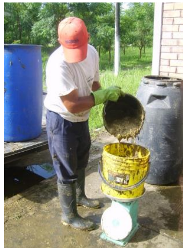
Fotografía 2. Pesaje del estiércol bovino para utilizarlo en los diferentes biodigestores según corresponda
