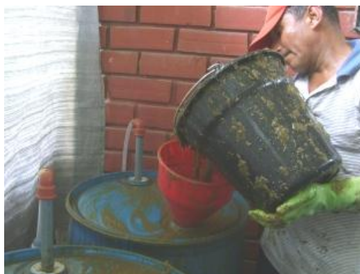
Fotografía 3. Introducción del estiércol fresco en los biodigestores respectivos
