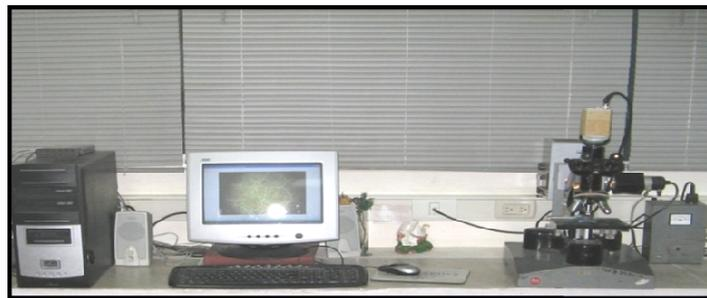
FIGURA 3.13. MICROSCOPIO LEITZ ASISTIDO POR COMPUTADORA
