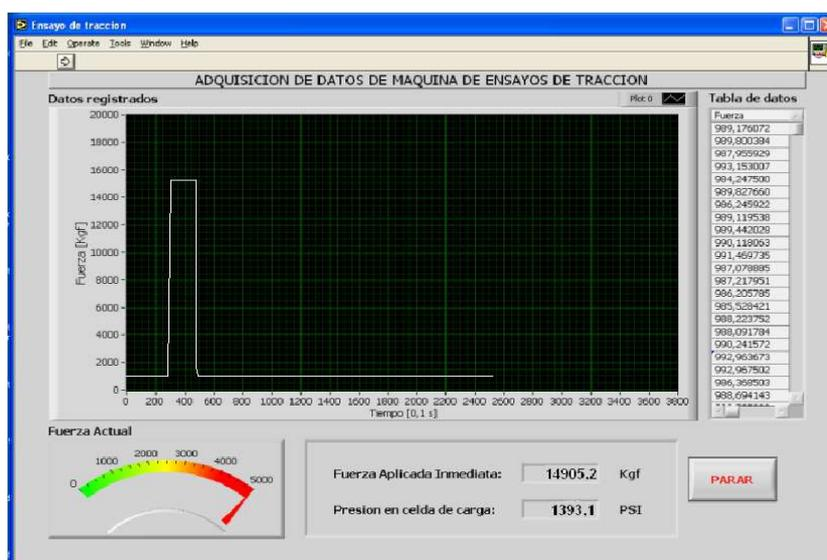
FIGURA 3.4. CURVA FUERZA VS TIEMPO, PROBETA 1 EXTRUIDA
