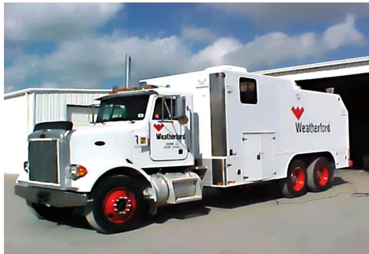
FIGURA 3.2 UNIDAD DE WIRELINE
