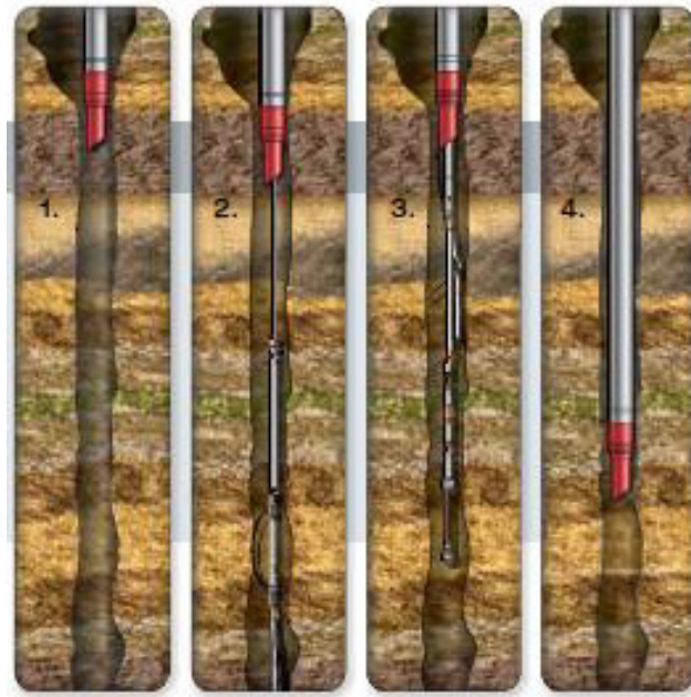
FIGURA 3.4 REGISTRO A TRAVES DE TUBERIA.
