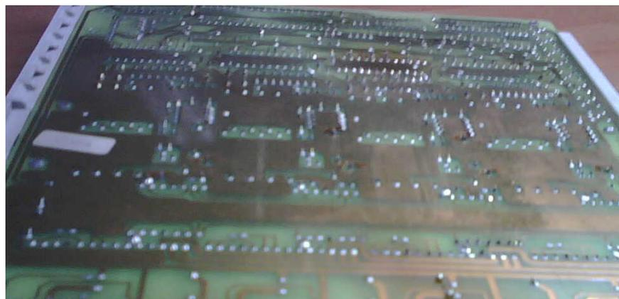
**Figura 1.10 Parte posterior de una tarjeta de abonado ERICSSON.**
