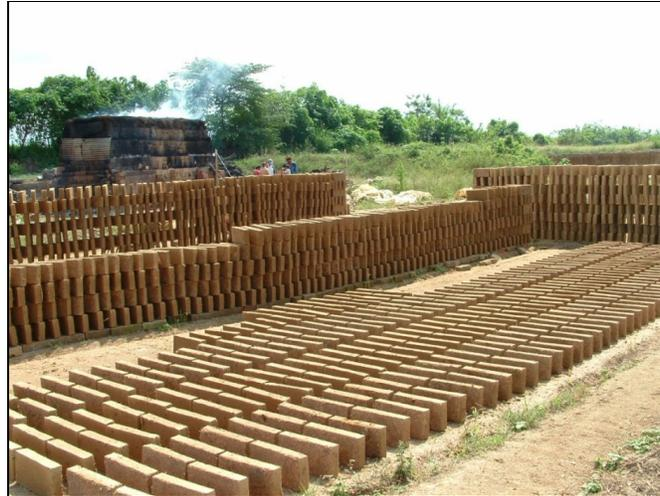
**FIGURA 3.10. Encadenado de ladrillos**
