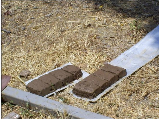
**FIGURA 5.5. LADRILLOS DISPUESTOS A SECADO**
