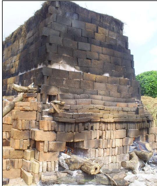
**FIGURA 3.11. Horno para quemado de ladrillos**
