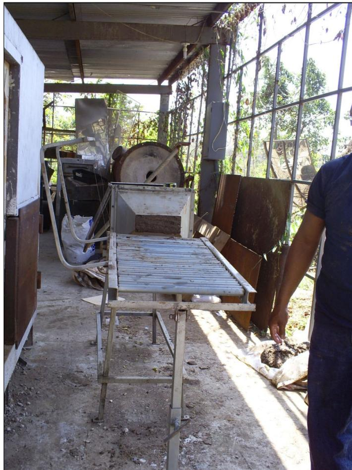
**FIGURA 5.3. EXTRUSION DE LADRILLOS CON PROTOTIPO**
