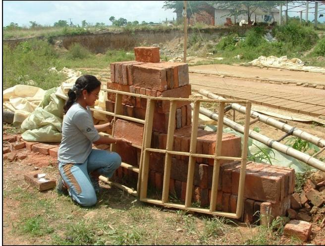
**FIGURA 3.7. Moldes utilizados**
