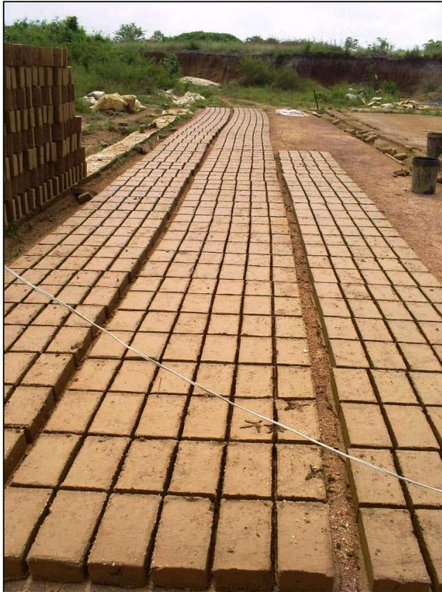
**FIGURA 3.8. Secado de ladrillos**
