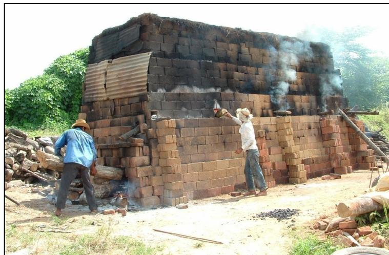
**FIGURA 3.12. Quemado de ladrillos**
